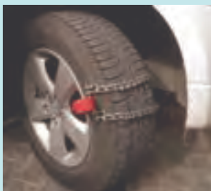
شکل ۳- زنجیر چرخ کمربندی یخ شکن
