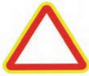
شکل ۱- نمایش حاشیه فلورسنت تابلوهای خطاری
