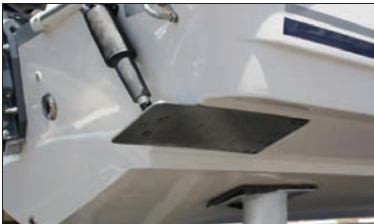
محل نصب تریم تب در بدنه شناور
