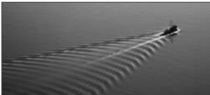
تشکیل امواج بر اثر حرکت شناور
