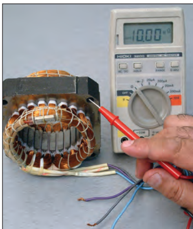
▲ شکل ۱۴-۲ تست اتصال بدنه
