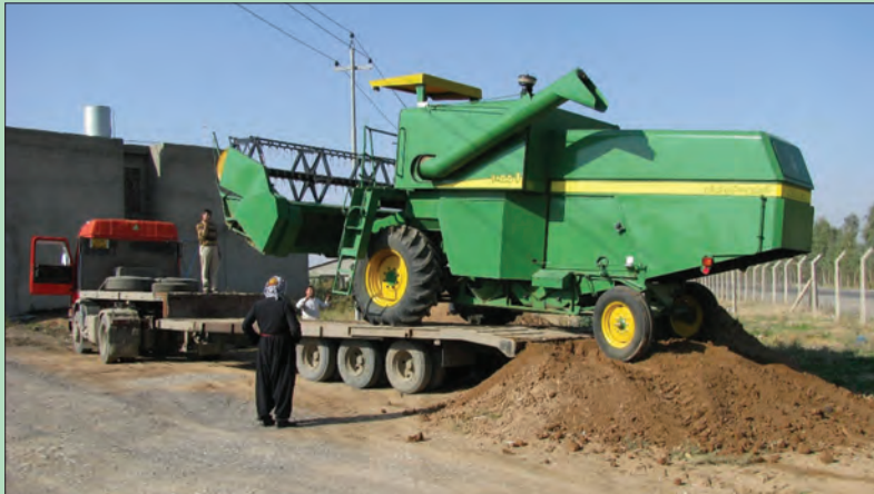
شکل ۳۵- نحوه قرار گرفتن کمباین روی یدک کش
