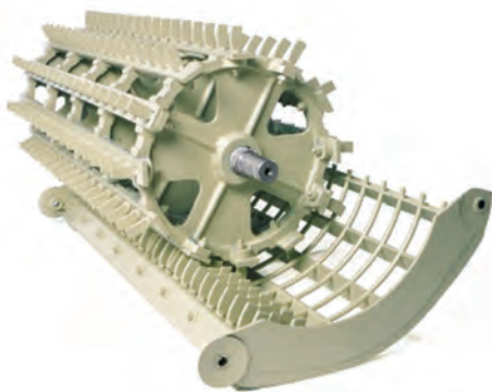
شکل ۱۸- کوبنده و ضد کوبنده چکشی
