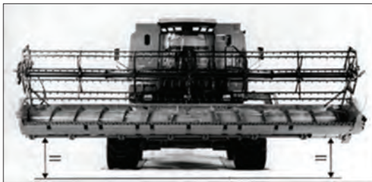
شکل ۳۷- اندازه‌گیری تراز بودن پلاتفرم
