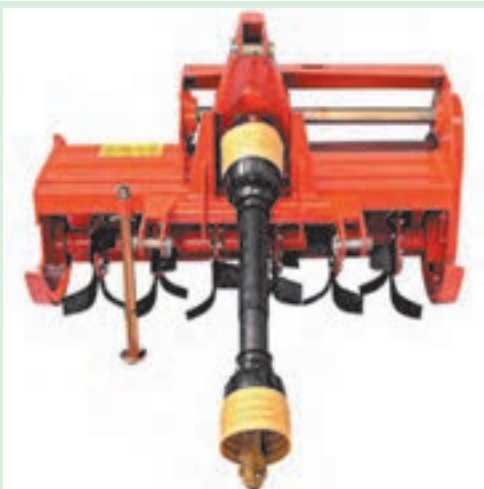
شکل ۲۵-۱. گاردان متصل به رتیواتور
