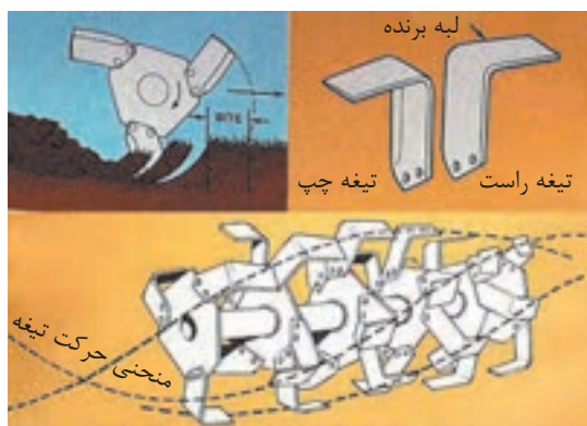
شکل ۱-۱۵. آرایش مارپیچ تیغه‌های گاوآهن دوار
