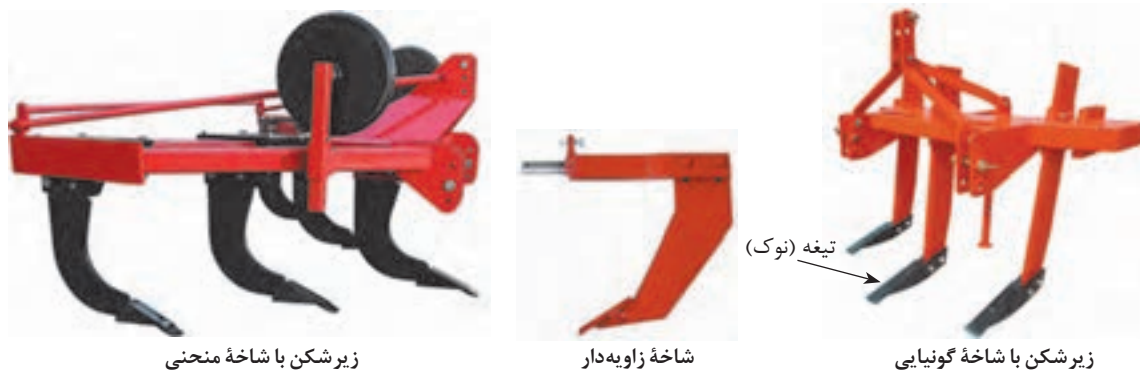
شکل ۱۲-۱. زیرشکن و انواع شاخه‌های آن
