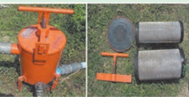
شکل ۵۷-۵. قطعات باز شده صافی توری
