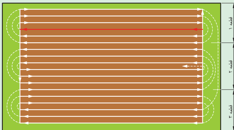
شکل ۳۸-۱. اجرای شخم به روش مداوم
