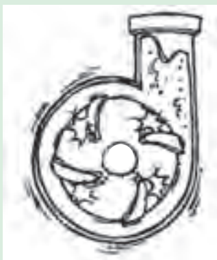
شکل ۲۹-۵. کاویتاسیون در پروانه پمپ
