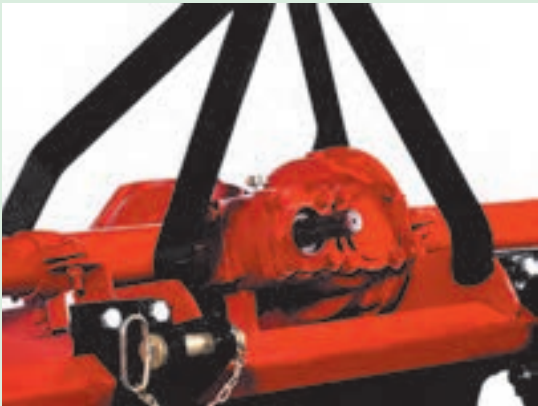
شکل ۲۳-۱. محور انتقال نیرو و نقاط اتصال
