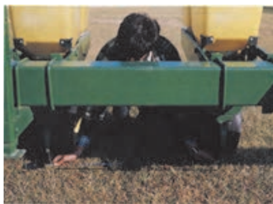
شکل ۲۵-۳. جابجایی ردیف‌های کاشت در ردیف کار
