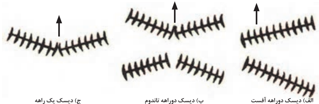
شکل ۶-۲. انواع دیسک از لحاظ آرایش گروه‌های بشقاب
