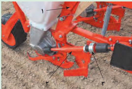
شکل ۲۷-۳. حذف واحد کارنده در یک نمونه ردیف‌کار
