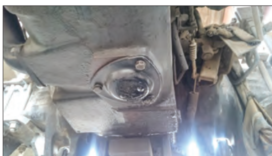
شکل ۳۲-۳- درپوش تخلیه روغن هیدرولیک تراکتور MF ۲۸۵
