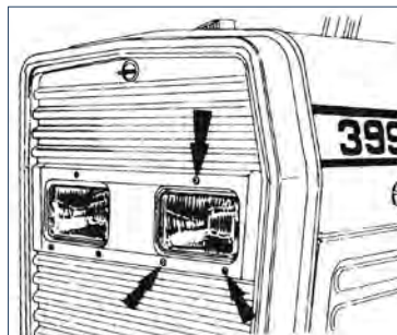
شکل ۱۸-۳ پیچ های تنظیم چراغ
