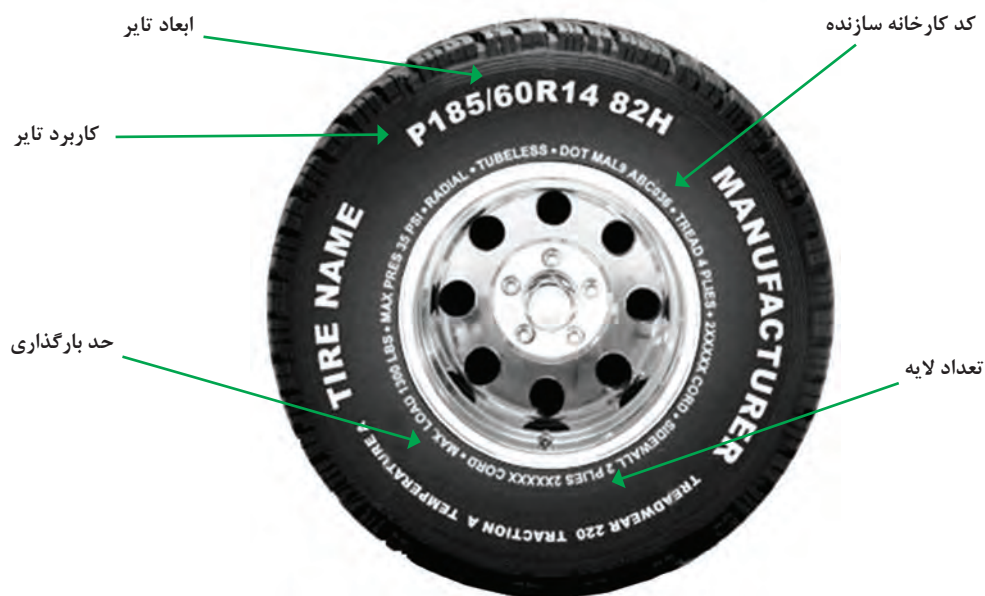
شکل ۱۳-۵- مشخصات فنی و ظاهری تایر
