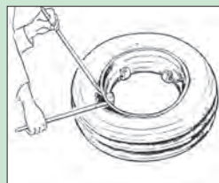
شکل ۵-۲۵ جدا کردن تایر از رینگ یک تکه
