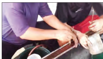
شکل ۴۲-۲ سیخ زدن رادیاتور
