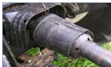
شکل ۳-۷۳- گاردان مجهز به کلاچ یک‌طرفه
