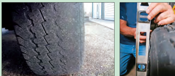
شکل ۴۳-۳ تأثیر تنظیم نبودن زوایای چرخ جلو
