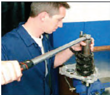
شکل ۱۲-۱ کار با ترک متر قابل تنظیم
