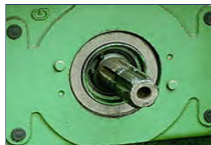
شکل ۳-۶۹- محور تواندهی ۶ خار
