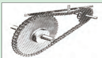
شکل ۱۲-۲ اندازه گیری کشش زنجیر
