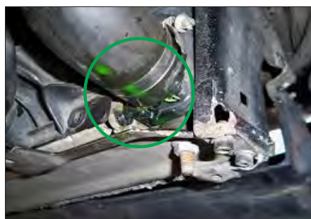
شکل ۵-۵۷- نشت آب از شیلنگ رادیاتور
