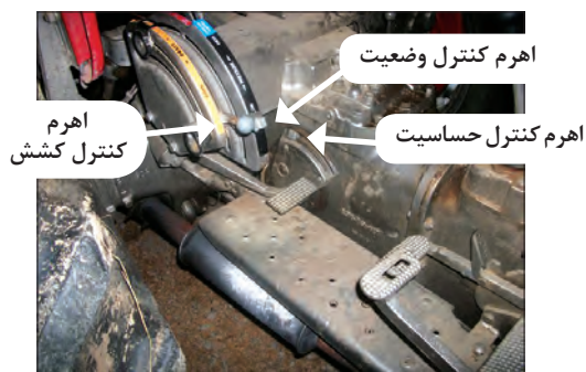
شکل ۳-۵۹- اهرم‌های کنترل هیدرولیک تراکتور فرگوسن ۲۸۵
