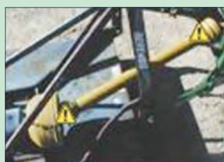
شکل ۷۶-۳- حداکثر زاویه گاردان ۲۵ درجه است.
