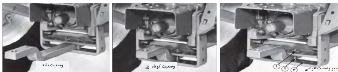
شکل ۵۷-۳ تنظیمات مالبند قابل تنظیم
