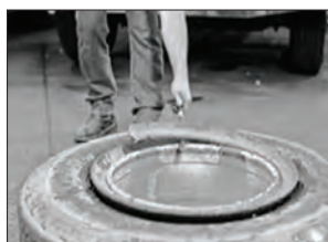
شکل ۵-۲۶ جدا کردن تایر از رینگ دو تکه
