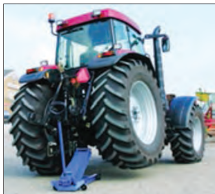
شکل ۲۲-۵ جک زدن زیر تراکتور
