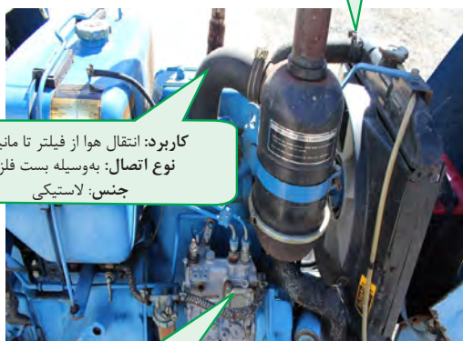
شکل ۵۵-۵- لوله‌ها و شیلنگ‌های موتور تراکتور
