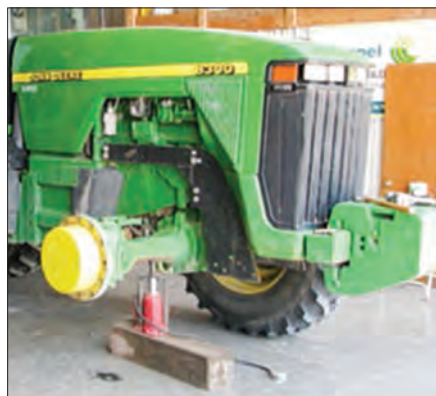
شکل ۲۲-۵ جک زدن زیر تراکتور
