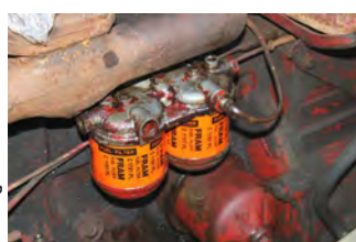
شکل ۵-۶۰- نشت گازوئیل از فیلتر
