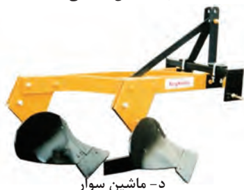
شکل ۳-۵۱-روش های اتصال ماشین های کشاورزی به تراکتور
