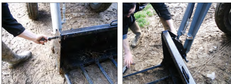
(الف) (ب) شکل ۳۱-۴- اتصال باکت‌ها به بیل
