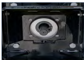
شکل ۳-۷۰- محور تواندهی ۲۱ خار
