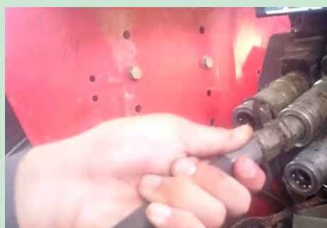
شکل ۶۶-۳- اتصال خروجی هیدرولیک
