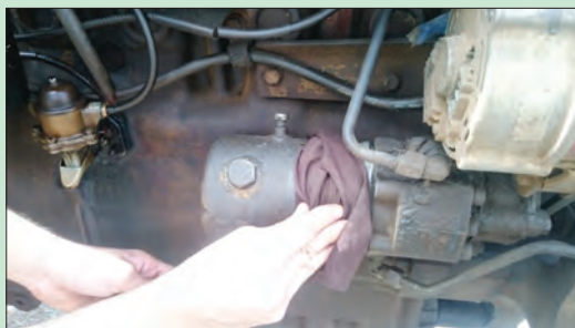
شکل ۴۱-۳- تمیز کردن پوسته روغن فرمان
