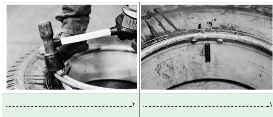
شکل ۳۲- ۵- الف - جازدن تایر روی رینگ دو تکه
