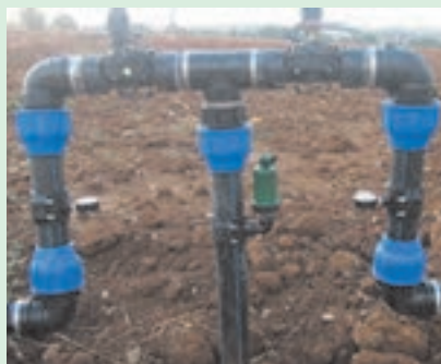
شکل ۳۲-۵. شیر و فشار سنج روی بال ها
