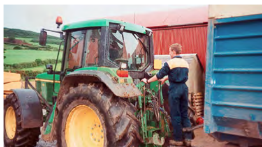
شکل ۴-۱۶- خطر ایستادن روی مالبند پی‌نورد و تراکتور
