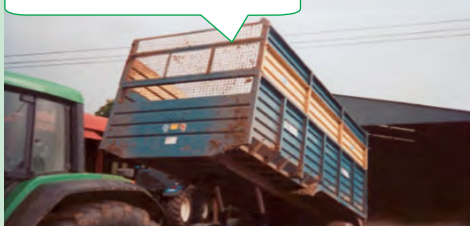
شکل ۲۷-۴ ارتفاع پی‌نورد را در هنگام تخلیه بار در نظر بگیرید.
