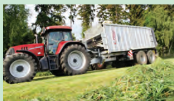
شکل ۴-۱۲- ضربه پی نورد به تراکتور در ترمزهای ناگهانی
