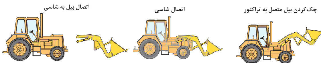
جدول ۴-۷- مراحل اتصال بیل به تراکتور
