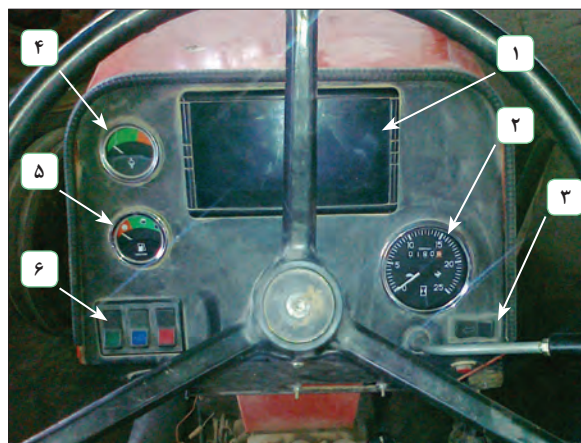
شکل ۳-۴- وسایل اندازه‌گیری و هشداردهنده تراکتور
