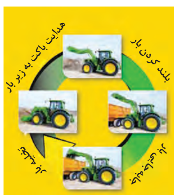
شکل ۳۷-۴ مراحل باربرداری با بیل
