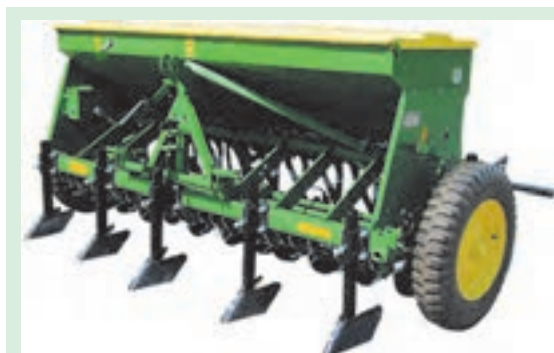
شکل ۲-۳۲. خطی کار مجهز به شیارکش
