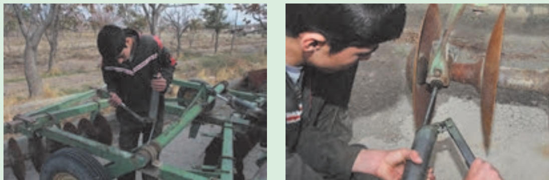
شکل ۱۶-۲. گریس کاری دیسک
