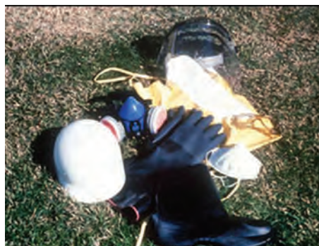
شکل ۱۲-۲ تجهیزات مورد نیاز برای عملیات سمپاشی
