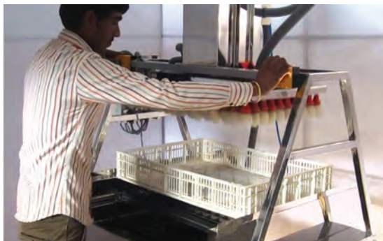
روش انتقال تخم‌مرغ‌ها به صورت نیمه خودکار در این روش با استفاده از دستگاه دستی مخصوص تخم‌مرغ‌ها از شانه‌های ستر به سبدها منتقل می‌شوند.
