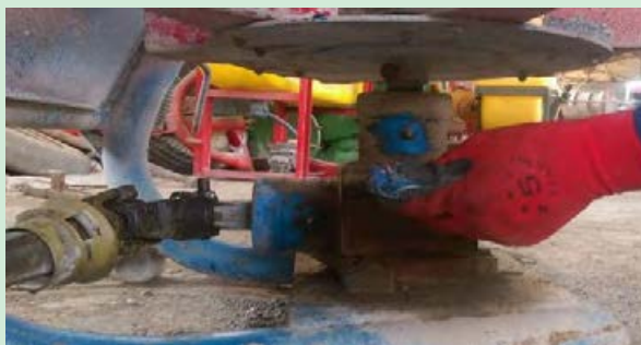
شکل ۱۳- تمیز کردن گریسخورها و مکان آنها
