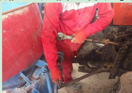
شکل ۱۰- اتصال بازوی وسط تراکتور به بذرپاش
