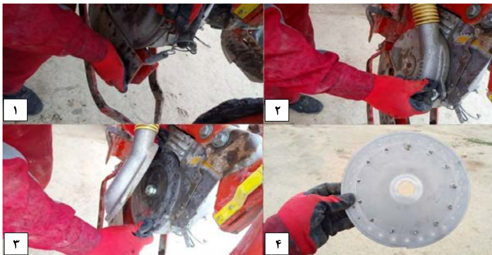
شکل ۲۲- تعویض موزع
