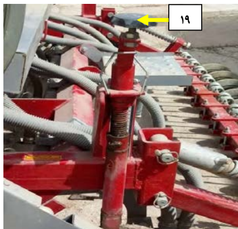
شکل ۳۹- اهرم تنظیم عمق کاشت
