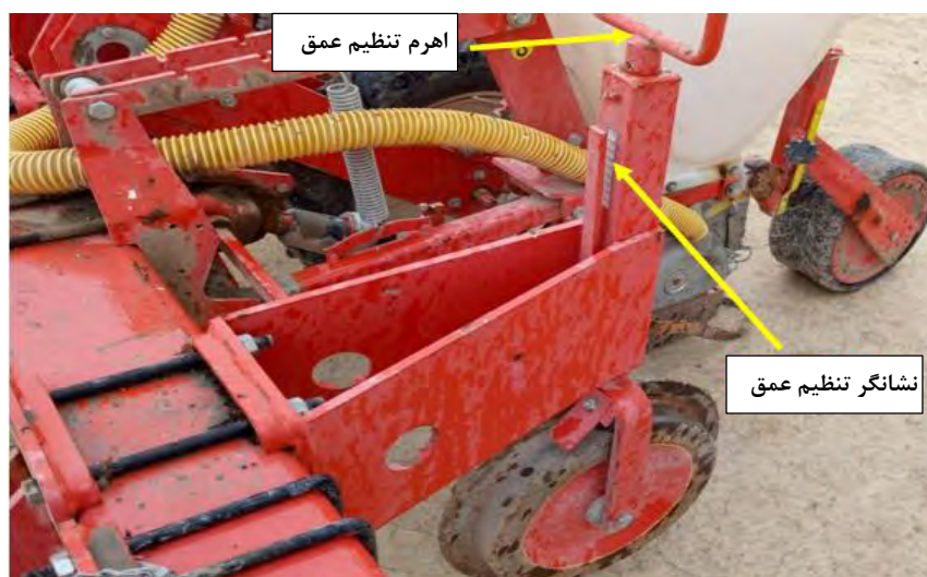
شکل ۱۸- تنظیم عمق کاشت
