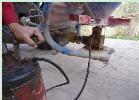
شکل ۱۵- گریس کاری گاردان و بذریاش
