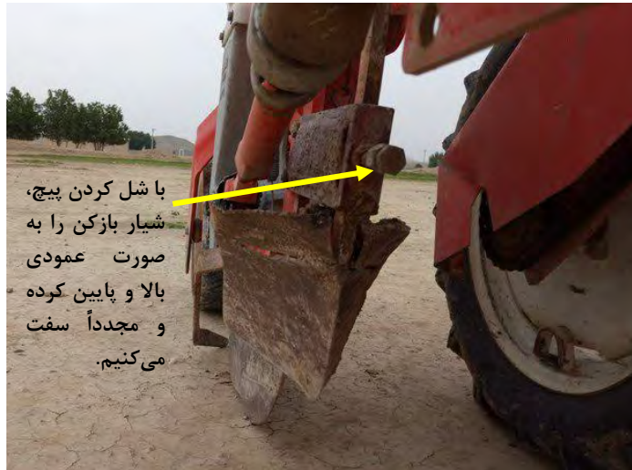
شکل ۲۰ - تنظیم شیار بازکن
