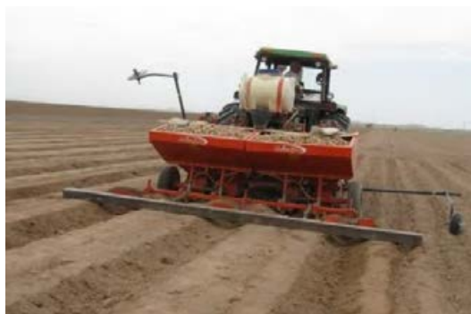
شکل ۳۳- غده‌کار تمام خودکار دو ردیفه
