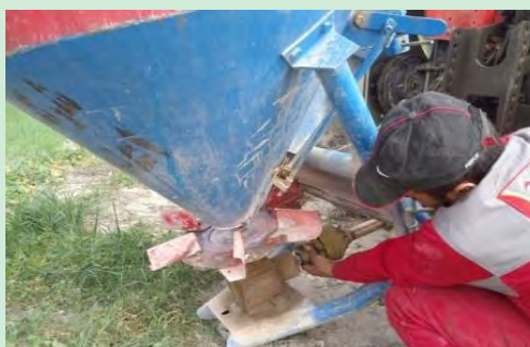
شکل ۹- نصب گاردان بین بذرپاش و تراکتور
