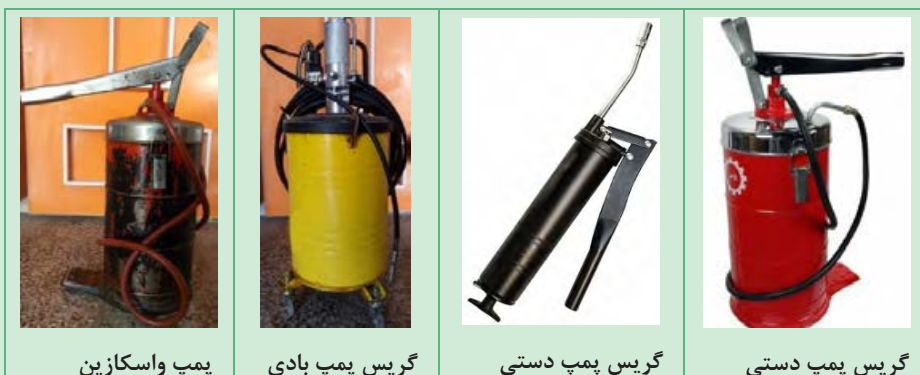
شکل ۱۴- نمونه هایی از گریس پمپ ها
