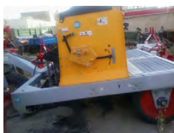
شکل ۴۹- ماشین دیم کار کششی با تک نقطه اتصال و شیلنگ های هیدرولیک
