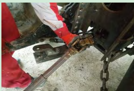
شکل ۹- نصب گاردان بین بذرپاش و تراکتور
