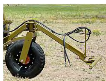
شکل ۴۹- ماشین دیم کار کششی با تک نقطه اتصال و شیلنگ های هیدرولیک
