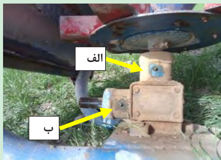
شکل ۱۳- تمیز کردن گریسخورها و مکان آنها
