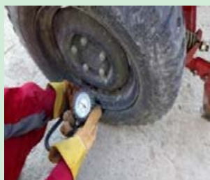
شکل ۱۲- تنظیم باد لاستیک
