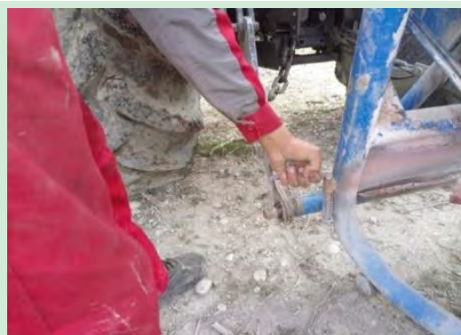
شکل ۸- اتصال بذرپاش به بازوهای کناری تراکتور
