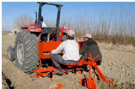
شکل ۳۲- غده‌کار نیمه خودکار دو ردیفه
