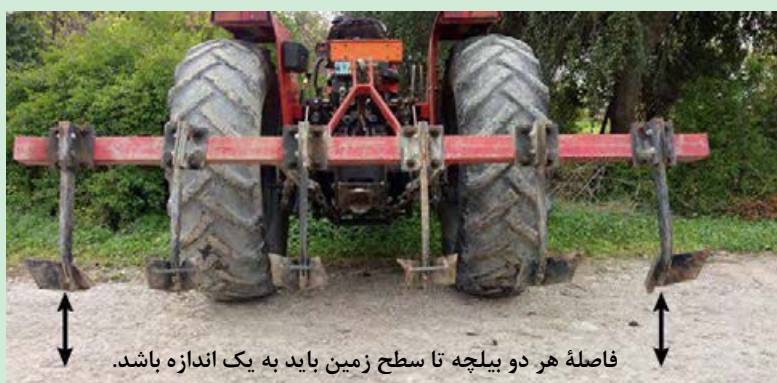
شکل ۱۴- تراز طولی شیارک
