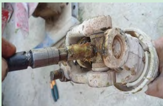
شکل ۱۵- گریس کاری گاردان و بذریاش
