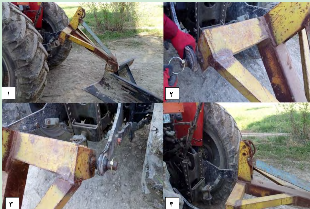
شكل ۲۲- روش اتصال نهركن به تراكتور
