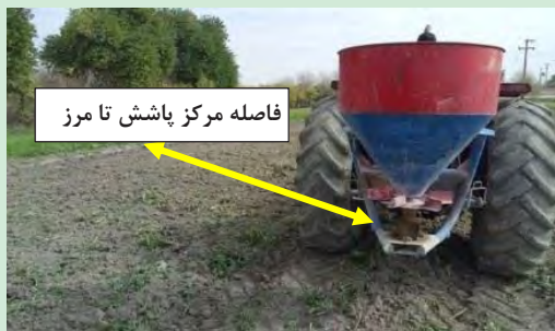
شکل ۱۹- کنترل فاصله پاشش بذر
