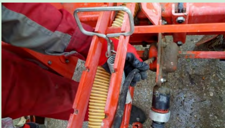
شکل ۱۲- گریس‌کاری تمام گریس خوره‌های ماشین ردیف‌کار
