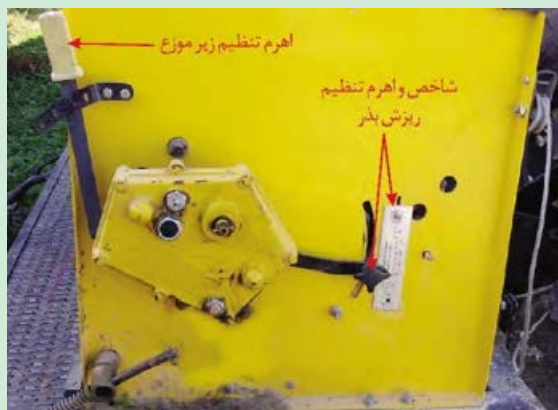
شکل ۱۷- اهرم تنظیم ریزش بذر
