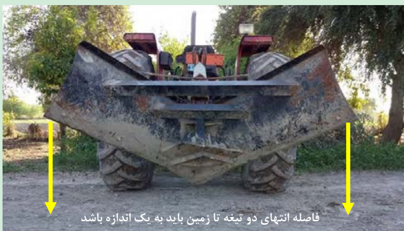
شکل ۲۵- تنظیم تراز عرضی نه‌رکن
