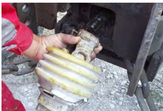
شکل ۱۱- اتصال گاردان به تراكتور
