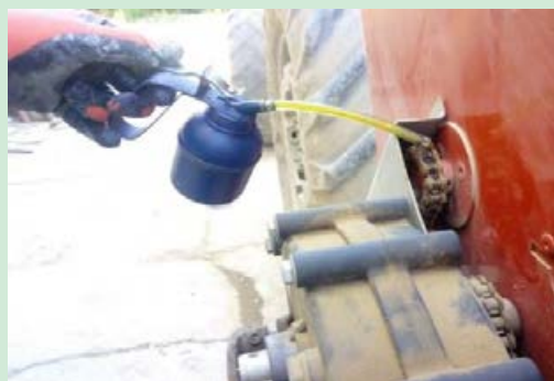
شکل ۴۳- روغن کاری چرخ دنده‌ها
