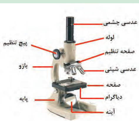
شکل ۲۳- اجزای مختلف نوعی میکروسکوپ
