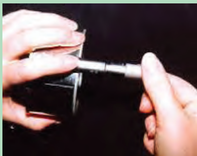
شکل ۱۹- اندازه‌گیری قلاب بدنه
