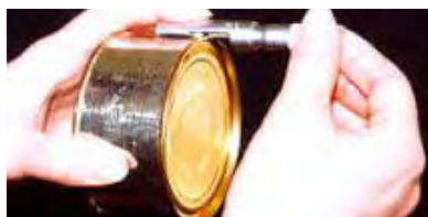
شکل ۳- اندازه‌گیری طول دوخت
