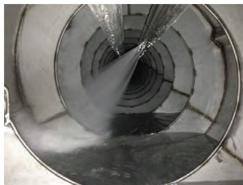
شکل ۵- شست‌وشوی افشانی با استوانه گردان
