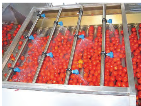
شکل ۶- شست‌وشو با پاشش آب
