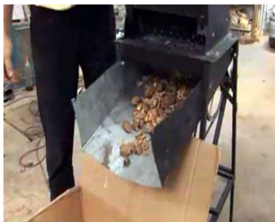
شکل ۳-۴- دستگاه مغز کن گردو
