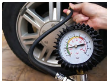
ب) اندازه‌گیری فشار هوای درون لاستیک خودرو
