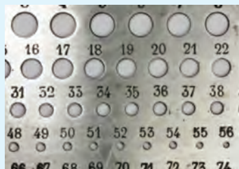
شابلون میله (اندازه گیری قطر میله‌ها)
