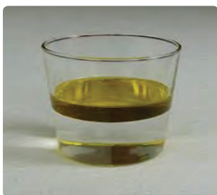
شکل ۳-۸ شناوری روغن بر روی آب
