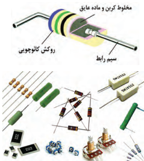
شکل ۵-۱۵ انواع مقاومت ثابت
