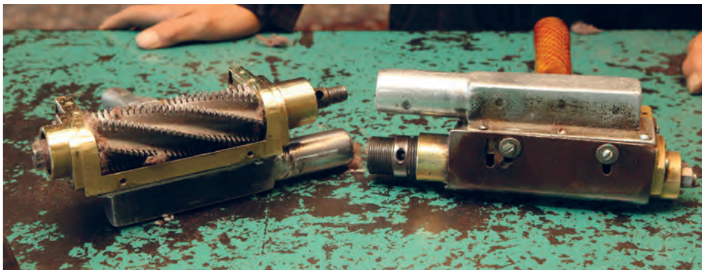
▲ تصویر ۵- ماکوی پرداخت و تیغه اره‌کشی
