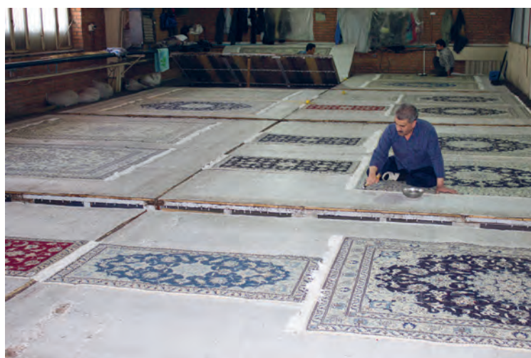
تصویر ۴- دارکشی با میخ و چنگک ▲
