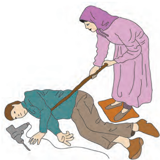
شکل ۸- نحوه صحیح جدا کردن فرد از برق
