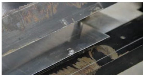
شکل ۶۴- قرار گرفتن پین در داخل پانچ
