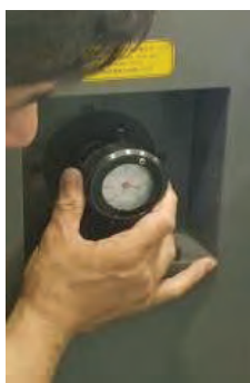
شکل ۳۸- گیج تغییر زاویه سیلندر ترانسفر
