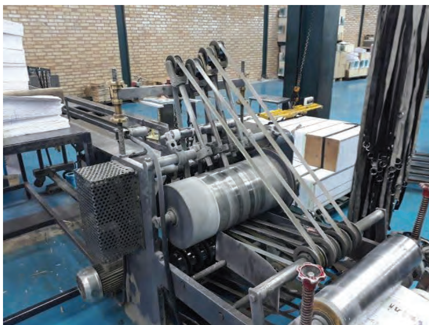
شکل ۴۸- سیلندر پرس و دسته کن (Stacker)
