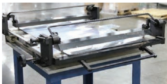
شکل ۶۳- قرار گرفتن پانچ پلیت بر روی پین
