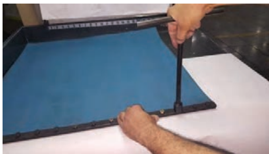
شکل ۶۰- نصب گیره لاستیک
