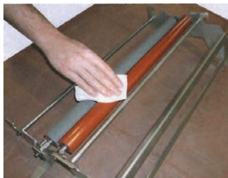
شکل ۳۰- تمیز کردن نوردهای فیوزر
