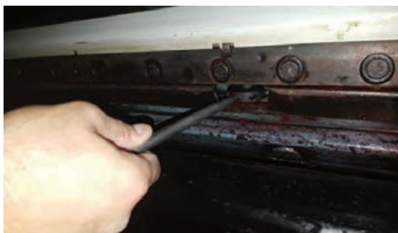
شکل ۸۴- پیچ تنظیم گیره
