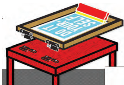
شکل ۲۶ - ۴ پیچ و لولا به همراه خروسک
