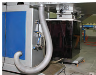
شکل ۱۶-۵ سیستم وکیوم میز دستگاه چاپ اسکرین
