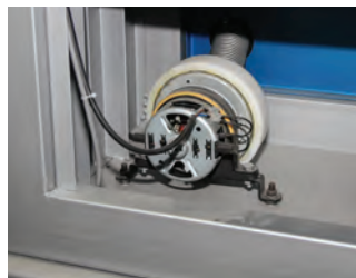
شکل ۱۶-۵ سیستم وکیوم میز دستگاه چاپ اسکرین
