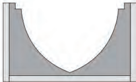
شکل ۴-۸۹ قالب یک بالشتک استاندارد
