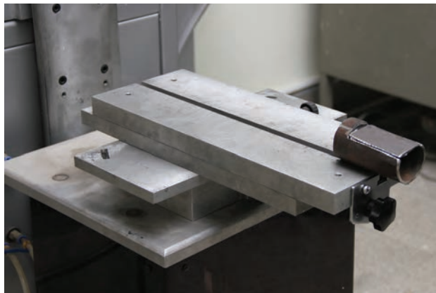
شکل ۵-۸ بستن قالب جای میز دستگاه
