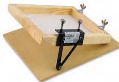
شکل ۲۴ - ۴ پیچ و لولا با پایه نگهدارنده شابلون
