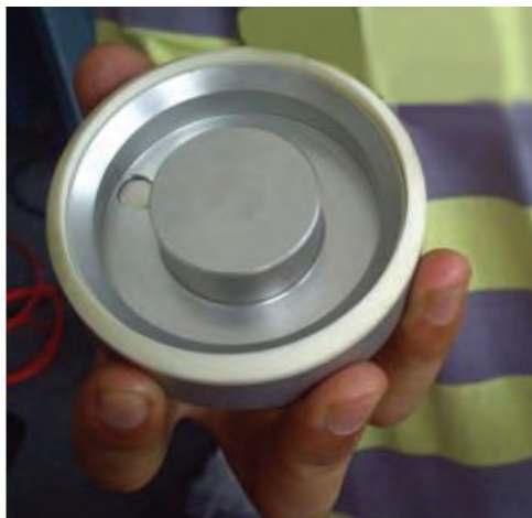
شکل ۴-۵۵ مخزن مرکب آهن ربای مرکزی
