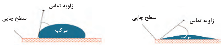
شکل ۳-۴۰ رابطه انرژی سطحی و زاویه تماس
