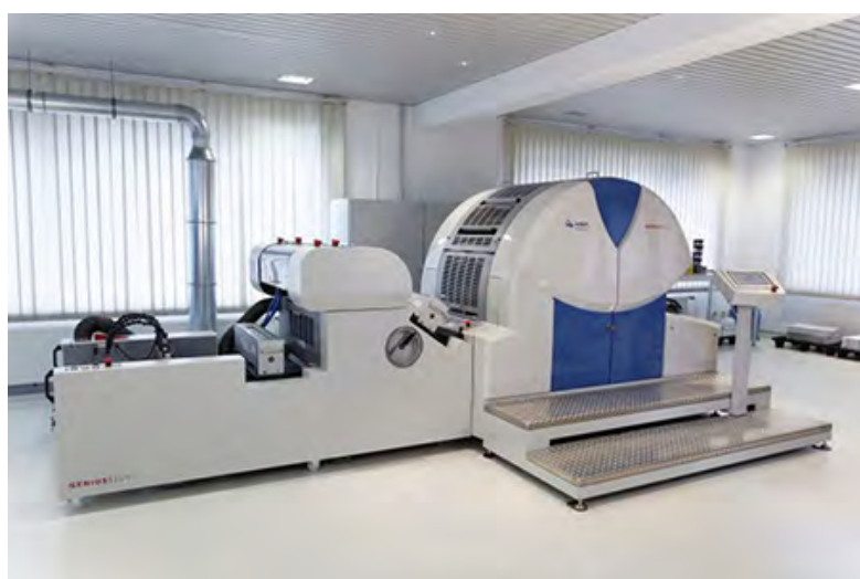
شکل ۳-۷۲- ماشین چاپ افست خشک (نمای خارجی)
