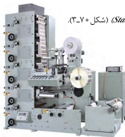
شکل ۳-۷۰ – ماشین چاپ فلکسوگرافی ایستاده
