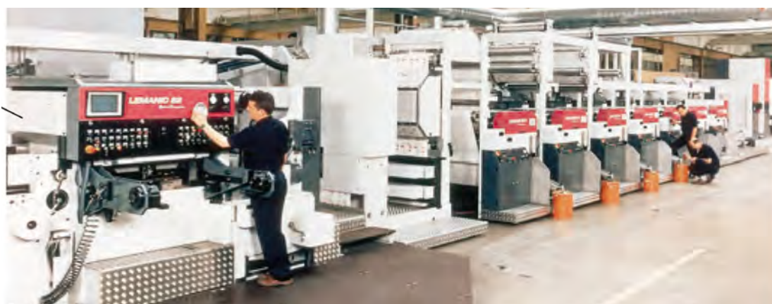
شکل ۳-۶۹ – ماشین چاپ فلکسوگرافی
