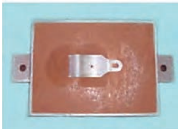
شکل ۲۱ سطح قالب‌های زیرین را پودر جدایش بزنید.
