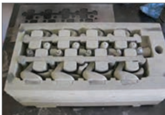
شکل ۲- قالب درجه زیرین یک قطعه صنعتی
