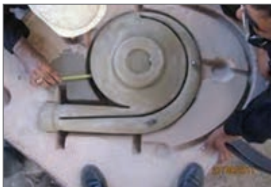
شکل ۳- قالب درجه زیرین یک پوسته دمنده هوا
