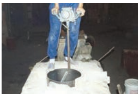
شکل ۱۹- نحوه کوبش دیواره کوره توسط کوبه ماشینی
