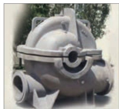
شکل ۱- روش قالب‌گیری CO 2 - دستی و قطعه ریختگی چدنی پوسته پمپ حلزونی ۲۰ تنی
