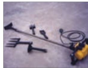
شکل ۱۲- کوبه ماشینی با سرهای قابل تعویض
