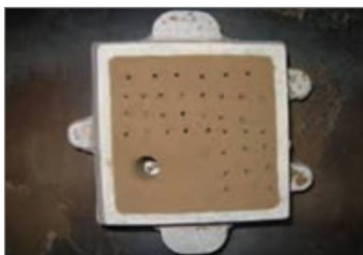
شکل ۱۴- تعبیه کانال‌های خروج هوا در درجه رویی و تعبیه کانال‌های خروج گاز ماهیچه پره دمنده
