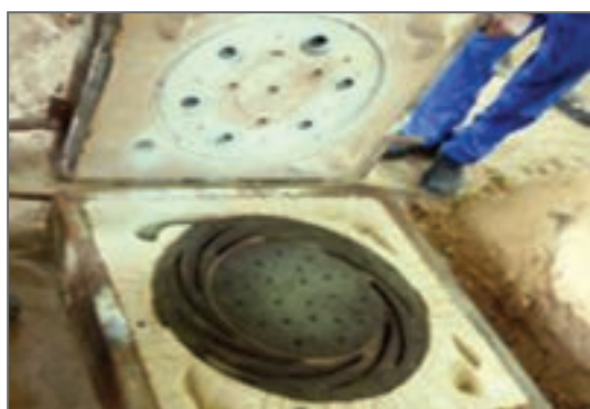
شکل ۱۴- تعبیه کانال‌های خروج هوا در درجه رویی و تعبیه کانال‌های خروج گاز ماهیچه پره دمنده
