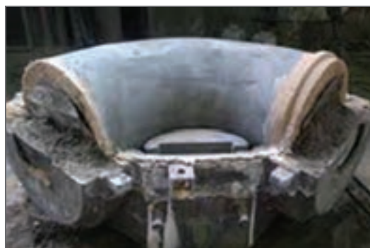
شکل ۱۷- ماهیچه زانویی پوشش داده شده
