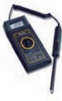
ترمومتر مقاومتی
