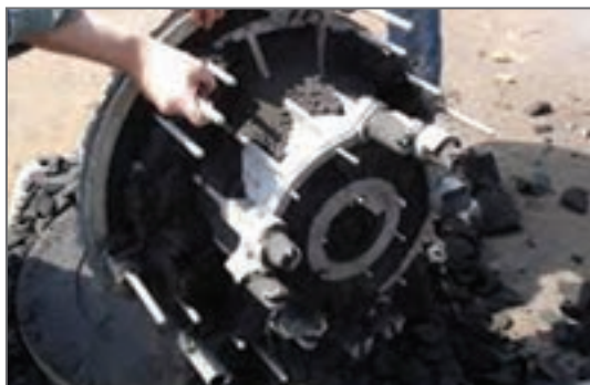
شکل ۱۰- قطعه هوزینگ ریخته شده سالم
