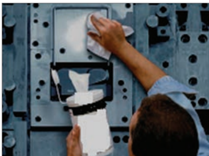
شکل ۱۰- تمیزکاری قالب‌های فلزی
