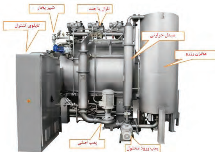
شکل ۷ تصویر قسمت‌های اصلی یک ماشین رنگری جت
