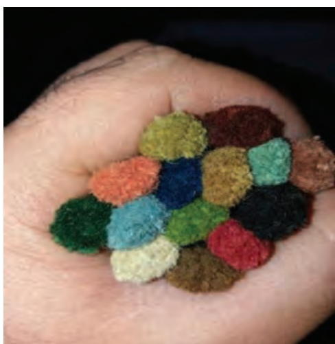
شکل ۲۱ تصویر دو روش گرفتن شید نخ رنگ شده برای مقایسه با نمونه‌ی رنگی سفارش داده شده در فرش
