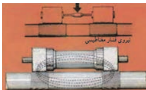
شکل ۲۸-۴ سیستم کشش با استفاده از فشار میدان مغناطیسی
