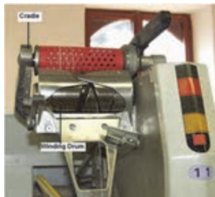
شکل ۴۶-۵ شروع پیچش یک قرقره جدید
