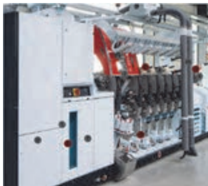
شکل ۴۷-۵ تمیز کننده خودکار اتوکنر
