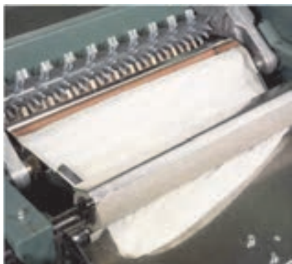
شکل ۳۷-۳ جمع کردن الیاف شانه شده و تبدیل آن به فتیله
