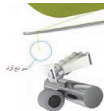
شکل ۷-۴ پیوند نیمه اتوماتیک نخ در ماشین این اند
