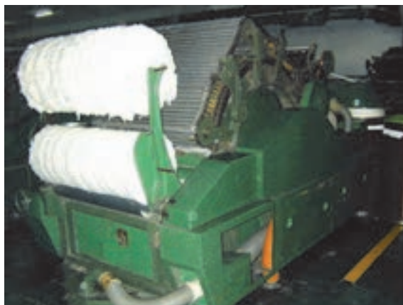
شکل ۴-۲ تغذیه کاردینگ با بالش
