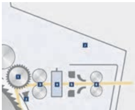
شکل ۲-۴۳ سیستم جمع آوری عنكبوتی با کنترل کیفیت فتیله
