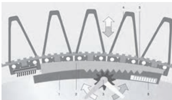
۲-۳۵ سیستم تنظیم فاصله کلاهدک و سیلندر PFS
