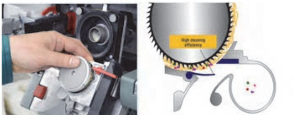
شکل ۱۱-۴ نمایی از سیستم تغذیه زننده ای در ماشین چرخانه ای و تنظیم
