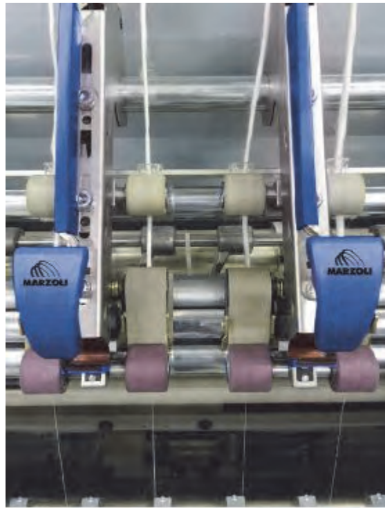
شکل ۷-۵ ج- تصویر واقعی سیستم کششی در رینگ
