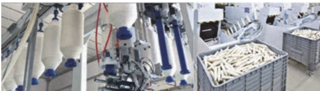
شکل ۳۰-۵ انتقال اتوماتیک بوبین های نیمچه نخ از فلایر به رینگ و جمع آوری ماسوره ها
