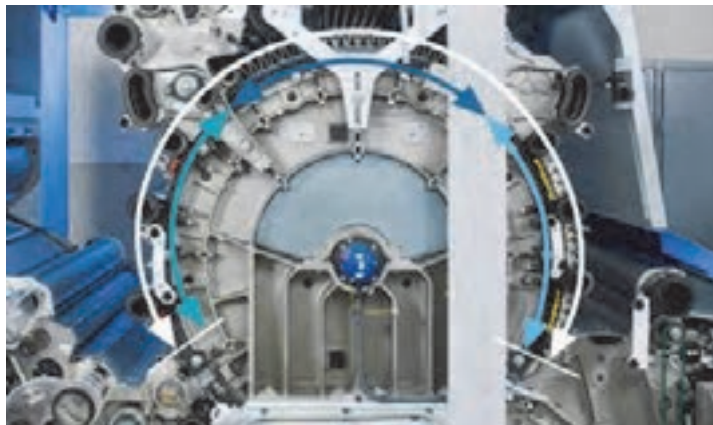
شکل ۱۴-۲ محلهایی که روی سیلندر اصلی عمل کاردینگ صورت می گیرد.
