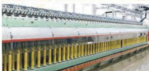
شکل ۴۸-۴ مراحل داف نیمه اتوماتیک
