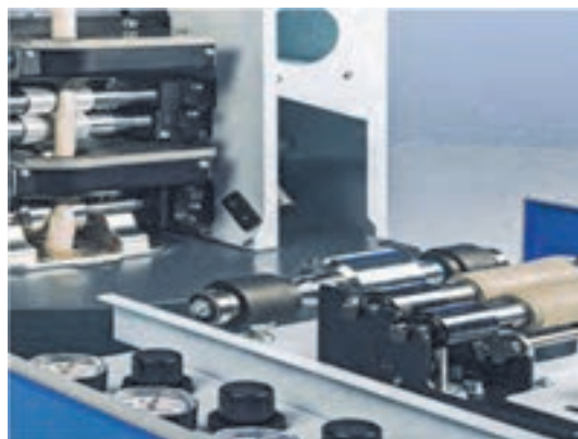
شکل الف ۱۱-۳ کالندر و اتولولر در چند لاکنی
