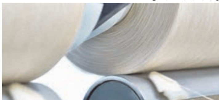
شکل ۴۱-۵ روش پیچش باتراورس
