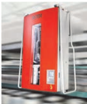
شکل ۸-۴ تصویری از پیوند زن های اتوماتیک بر روی ماشین چرخانه ای
