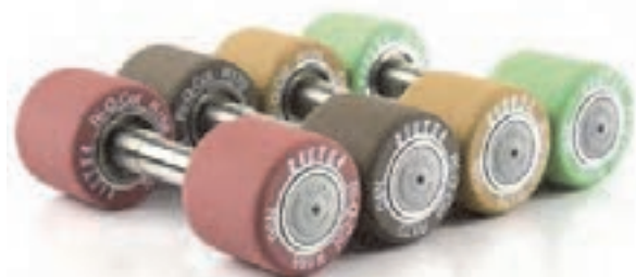
شکل ۹-۵ غلتک با روکش لاستیکی فوقانی سیستم کشش
