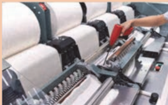
شکل ۴۲-۲ روش پرزگیری با تفنگی پرز گیر
