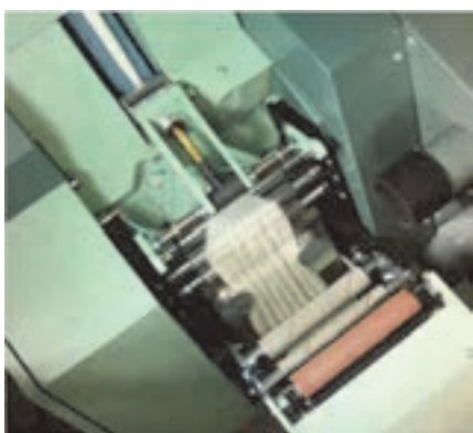
شکل ۳-۳۹ قسمت کشش در ماشین شانه
