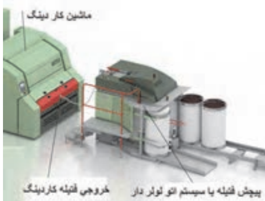
شکل ۲-۴۷ سیستم کشش اتولولردار جلو کاردینگ
