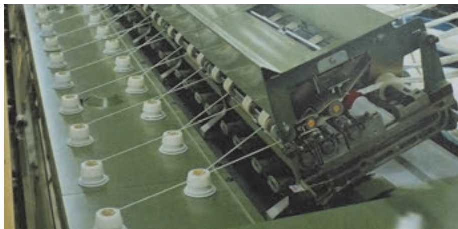
شکل ۴-۳۳ خروج نیمچه نخ از منطقه کشش
