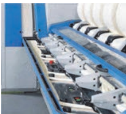
شکل ۳۸-۳ انتقال فتیله ها به بخش کشش از روی سینی انتقال
