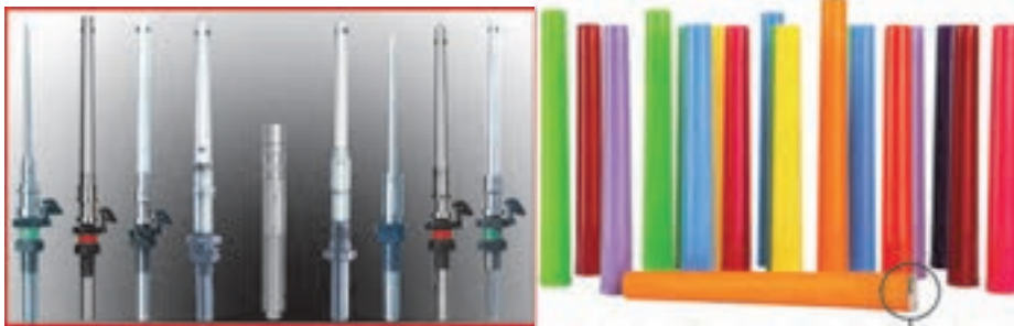
شکل ۵-۲۴ انواع ماسوره پلاستیکی رینگ و انواع اسپیندل رینگ
