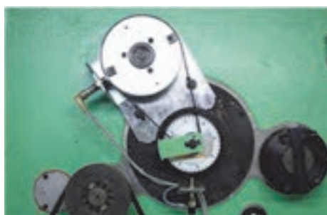
شکل ۳-۳۵ چرخ مدرج انتقال نیرو به اجزاء شانه
