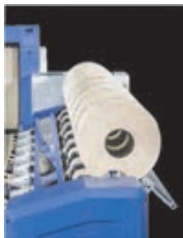
شکل ۳۱-۳ بخش باز شدن لایه بالشچه یا تغذیه
