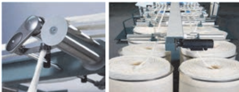
شکل ۲-۳، قسمت تغذیه ماشین هشت لاکنی فتیله و راهنمای فتیله
