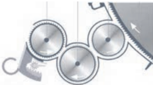
شکل ۷-۲ سیستم Web Feed سه سیلندر
