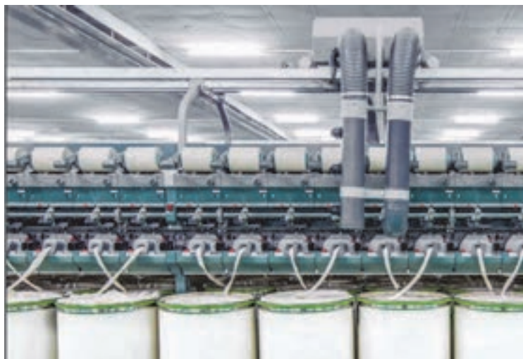
۴-۱۶ تمیز کننده سیار روی ماشین چرخانه
