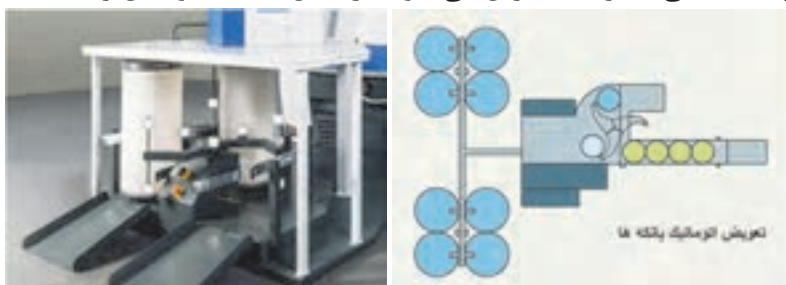
شکل ۲-۵۰ تعویض اتوماتیک بانکه در ماشین کاردینگ با جا به جایی بانکه
