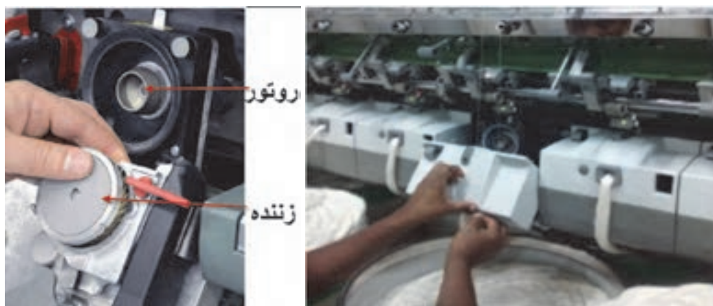
شکل ۶-۴ پیوند نخ در داخل روتور
