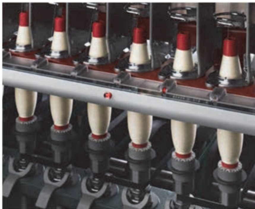
شکل ۳-۵ فاصله دو دوک متوالی در دستگاه رینگ
