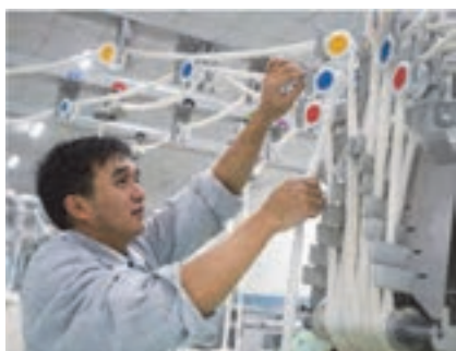
شکل ۳-۲۱ ناحیه کشش و صفحه تغذیه راهنمای فتیله در ماشین بالشچه
