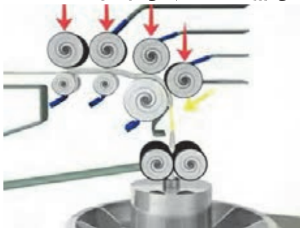
شکل ۸-۳ چگونگی قرار گرفتن غلتک های کشش و غلتک کاندر
