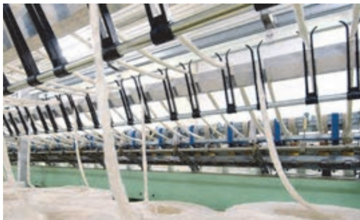
شکل ۴-۲۲ سیستم هدایت فتیله روی قفسه ماشین فلایر
