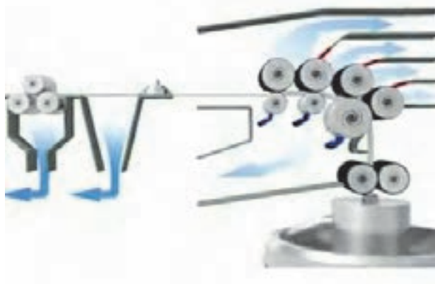
در شکل ۱۰-۳ سیستم خود تمیز کنندگی
