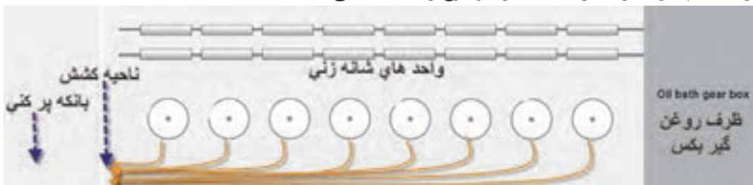
شکل ۳-۴۱ نحوه تولیدگیری در ماشین شانه
