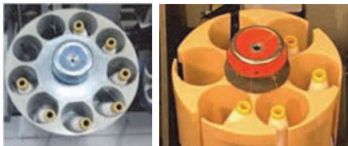
شکل ۳۶-۵ دو نمونه ماگازین ۶ و ۱۰ تایی
