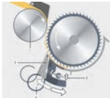
شکل ۸-۲ تنظیم چاقوی تمیز کننده
