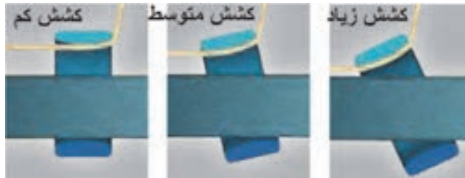
شکل ب ۵-۲۳ انواع سطح مقطع شیطانک و میزان کشش نخ
