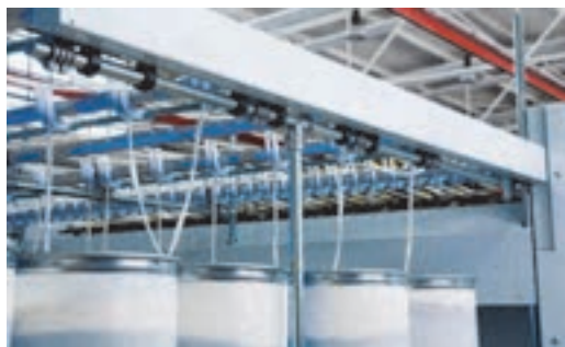
شکل ۲۱-۴ نمای قفسه دستگاه فلایر
