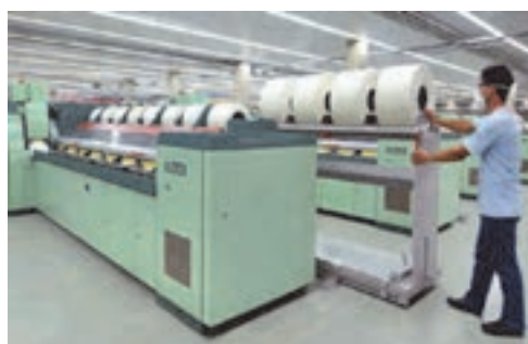
شکل ۲۵-۳ انتقال قفسه بالشچه به قسمت تغذیه شانه
