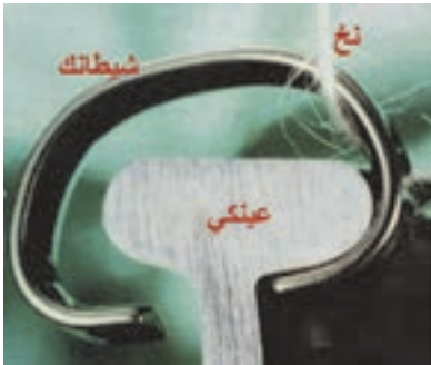
شکل ۱۸-۵ محل عبور نخ از بین شیطانک و عینکی می‌گذرد
