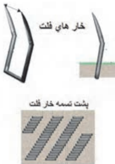
شکل ۲۹-۲ شکل سوزن های انعطاف پذیر فلت باروکش مناسب
