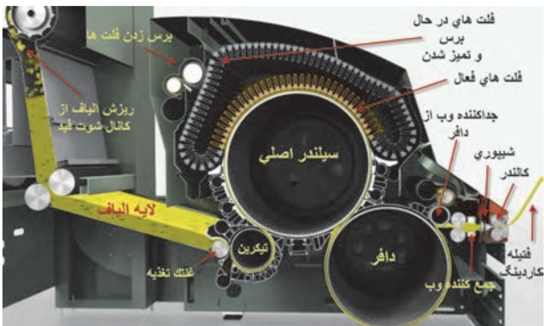
شکل ۳-۲ برش یک ماشین کاردینگ
