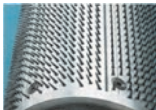
شکل ۱۰-۱ زنده خاردار با تراکم متوسط
