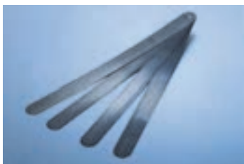
شکل ۲-۱۸ دسته فیلر برای گیج گذاری کاردینگ
