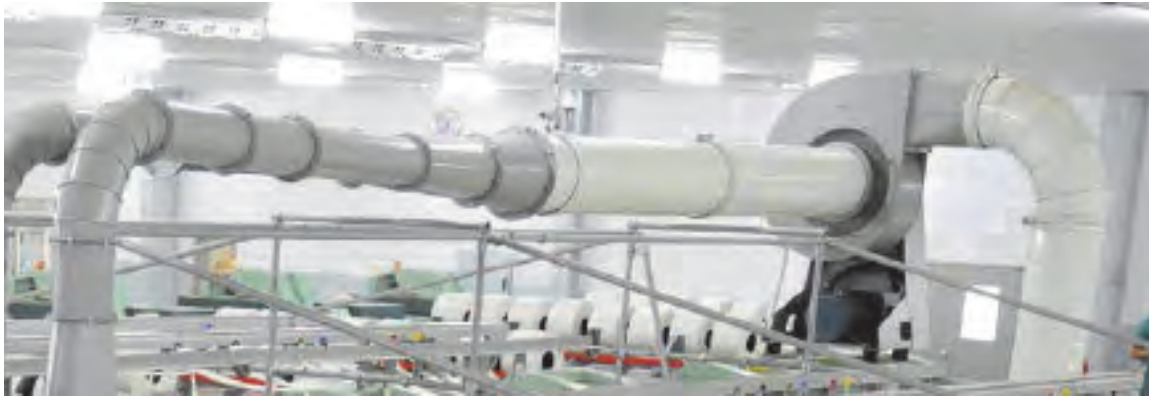
شکل ۱-۳۵ تقویت فشار انتقال الیاف
