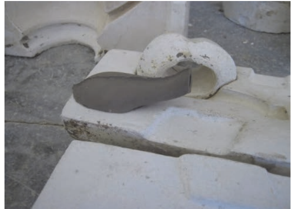
شکل ۴۲- شکل‌دهی جداگانه لوله و بدنه قوری
