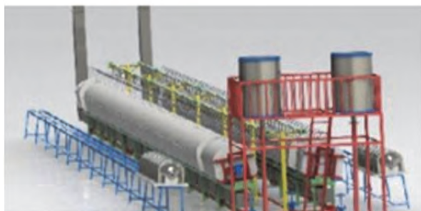
ب) قرار دادن مخزن دوغاب در ارتفاع
