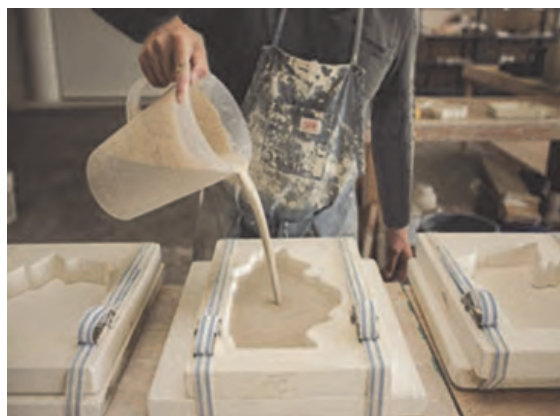
الف) ریخته‌گری دوغابی به روش دستی
