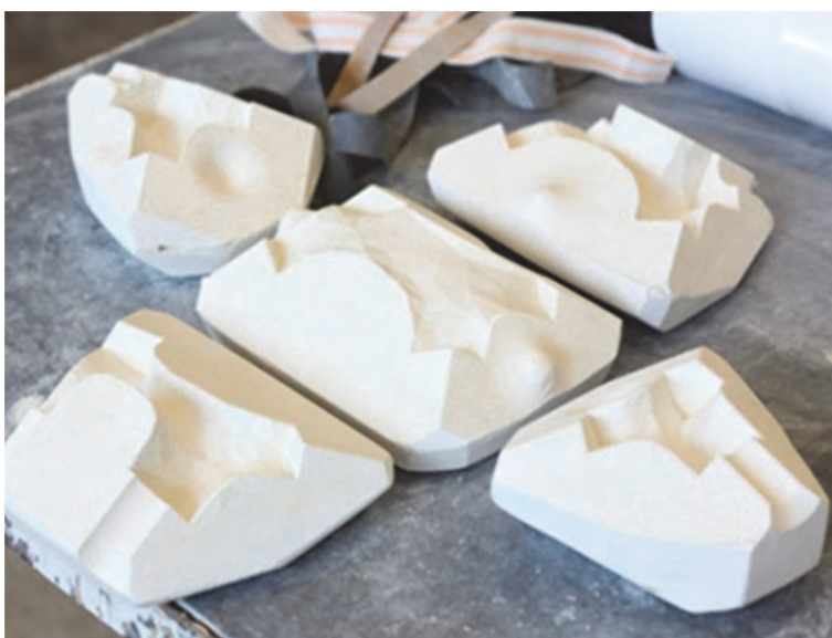
شکل ۴۸- قالب با زاویه‌های متعدد
