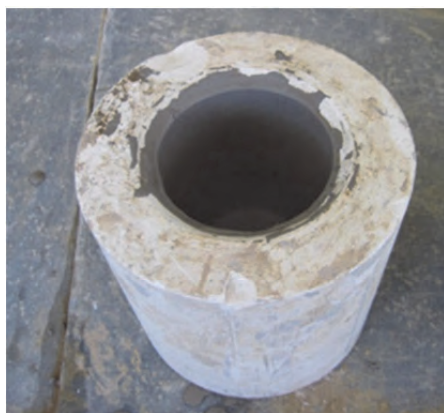
شکل ۹- قالب نمونه برای تعیین سرعت ریخته گری
