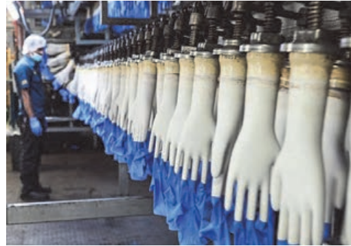
شکل ۱- قالب مورد استفاده در تولید دستکش
