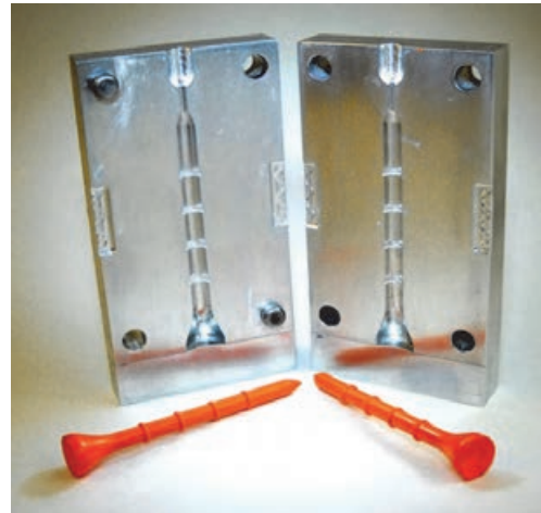
شکل ۳- قالب مورد استفاده در تولید میخ
