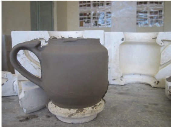
شکل ۴۲- شکل‌دهی جداگانه لوله و بدنه قوری
