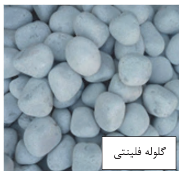
شکل ۱۸- گلوله‌های آلومینایی و فلینتی بال‌میل
