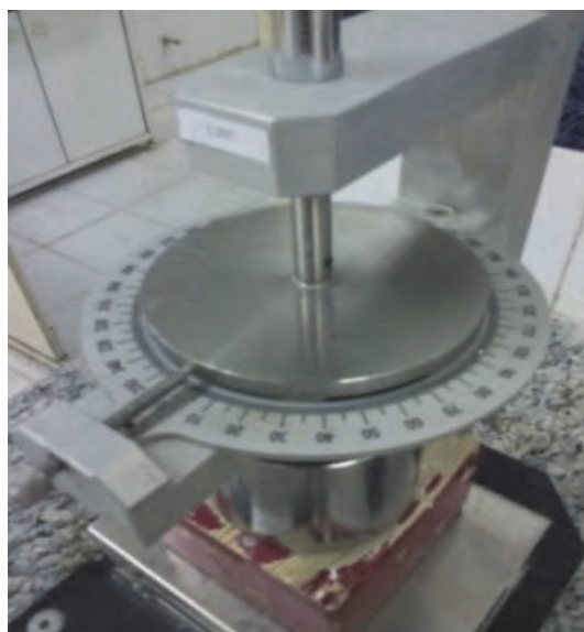
شکل ۱۱- ویسکوزیومتر پیچشی
