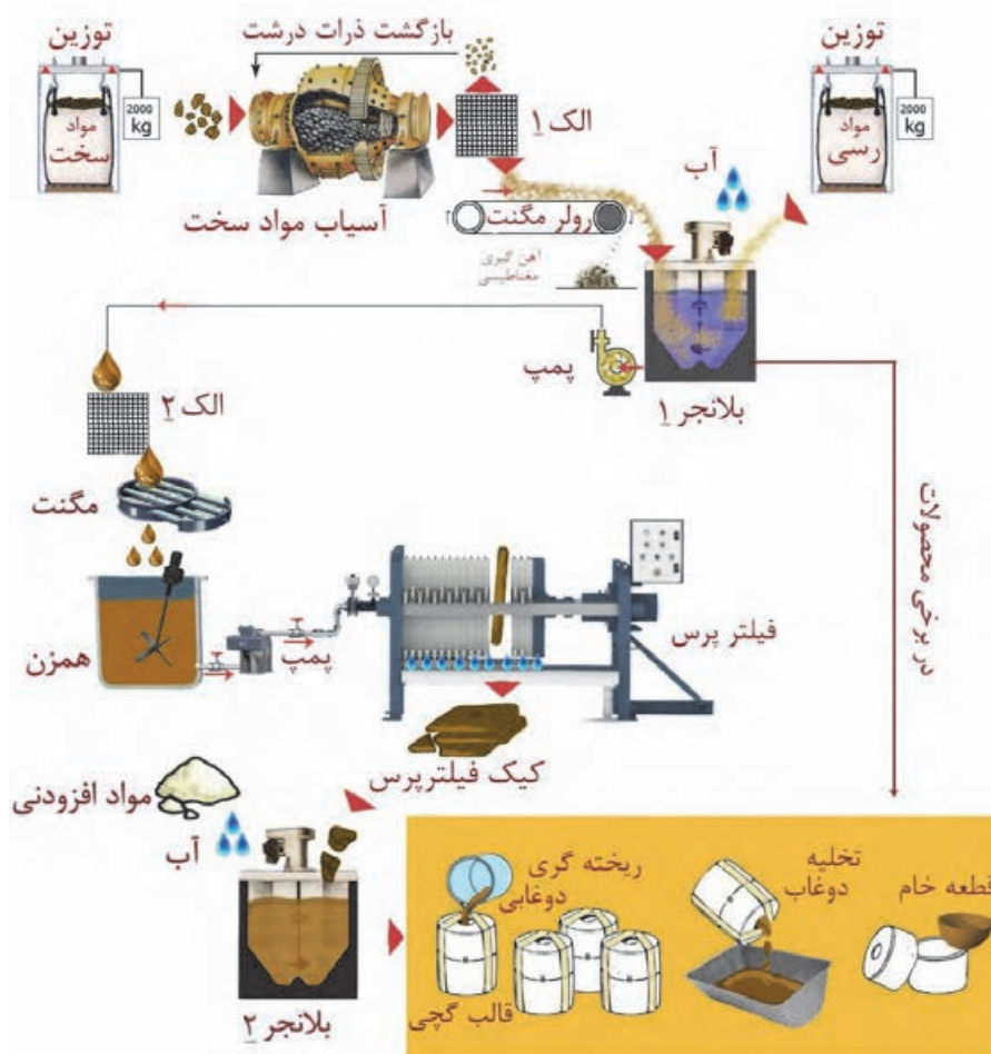
شکل ۱۱- فرایند ساخت دوغاب و شکل‌دهی قطعه
