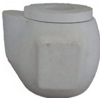
شکل ۲۷- قالب قوری درزبندی شده
