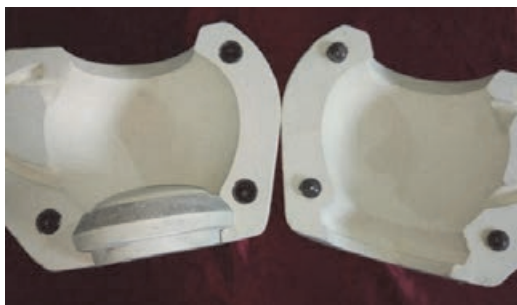
شکل ۲۴- الگوی گچی با زبانه‌های پلاستیکی
