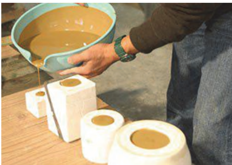
شکل ۴۷- پر کردن قالب با سرعت مناسب
