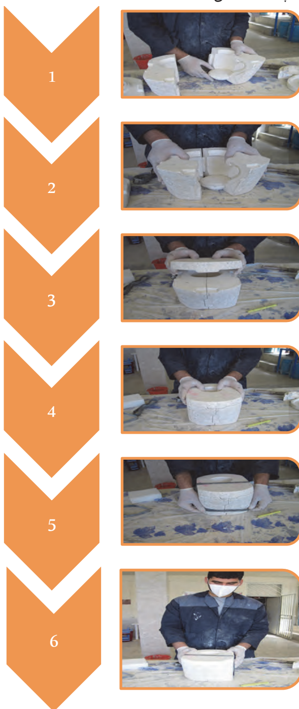
شکل ۷- مراحل بستن قالب
