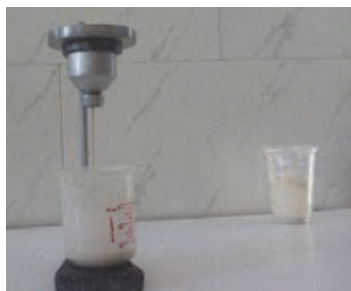
شکل ۹- ویسکوزیومتر ریزشی
