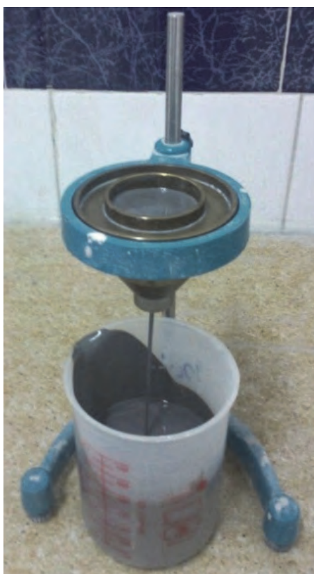
شکل ۸- ویسکوزیومتر ریزشی
