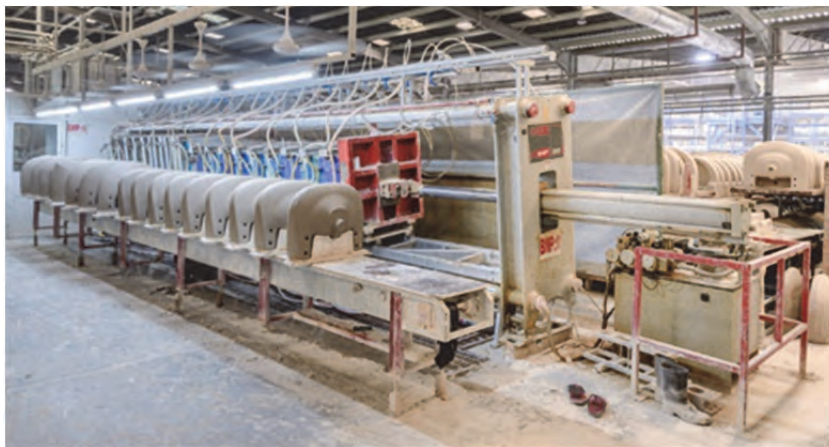
شکل ۶- ریخته‌گری دوغابی با فشار پایین
