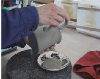
شکل ۴۳- دوغاب با روانی کم برای مونتاژکاری
