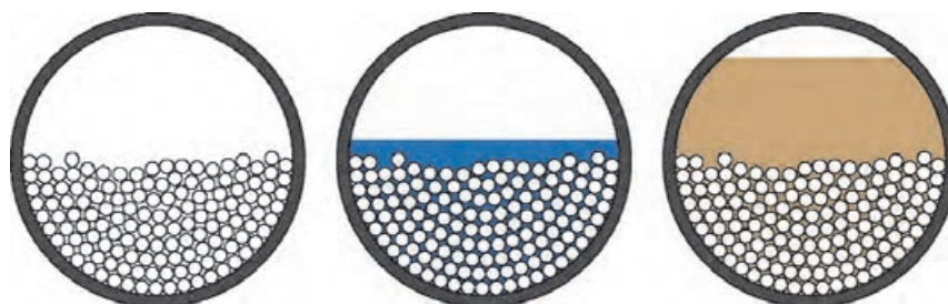
شکل ۱۷- محتویات فضای داخلی بال‌میل
