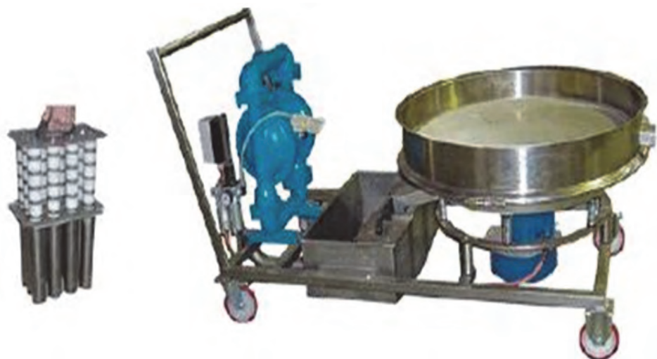
شکل ۲۶- گاری الک، آهن‌ربا و پمپ
