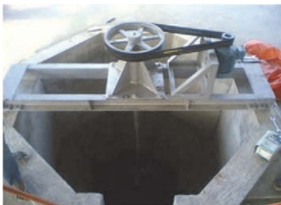
شکل ۲۸- دستگاه بلانجر
