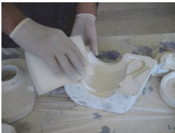
شکل ۴- زدودن گرد و غبار از قالب
