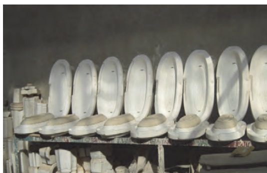
شکل ۲۸- باز کردن قالب
