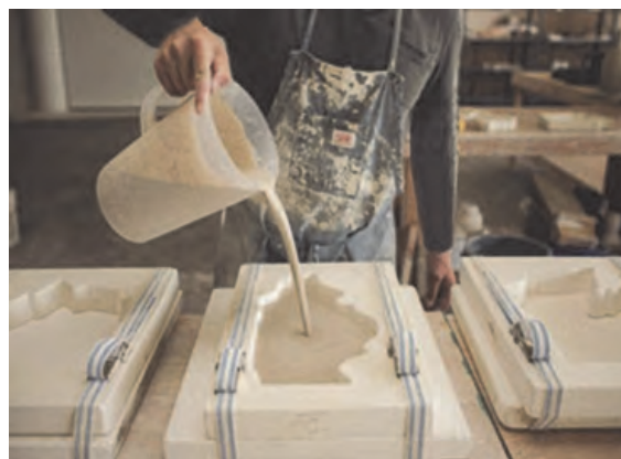
الف) ریخته‌گری دوغابی به روش دستی
