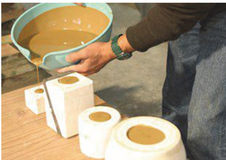
شکل ۴۷- پر کردن قالب با سرعت مناسب
