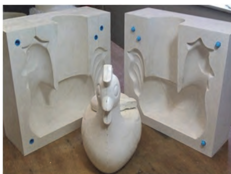
شکل ۶- پین‌های قالب‌های متعدد
