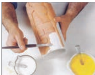
شکل ۱۱- اعمال لعاب بر روی سطح بیرونی قطعه
