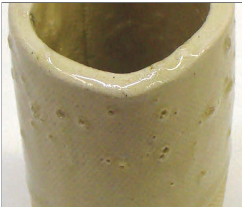
شکل ۳۵- عیب تاول زدن لعاب
