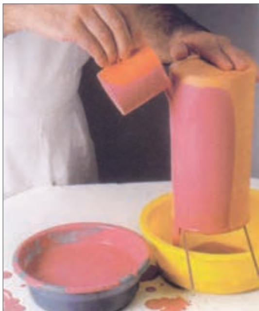
شکل ۱۴- اعمال لعاب به روش ریختنی
