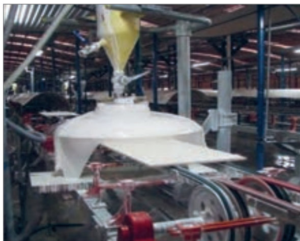
شکل ۲۳- لعاب‌زنی به روش آبشاری
