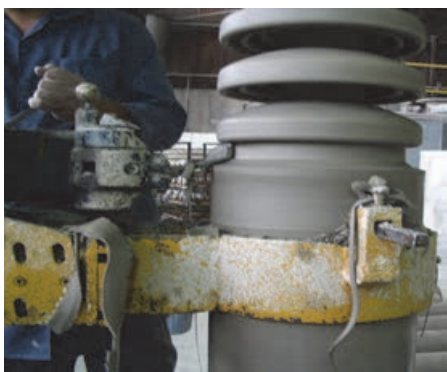
شکل ۵- شکل‌دهی قطعات سرامیکی به روش تراش
