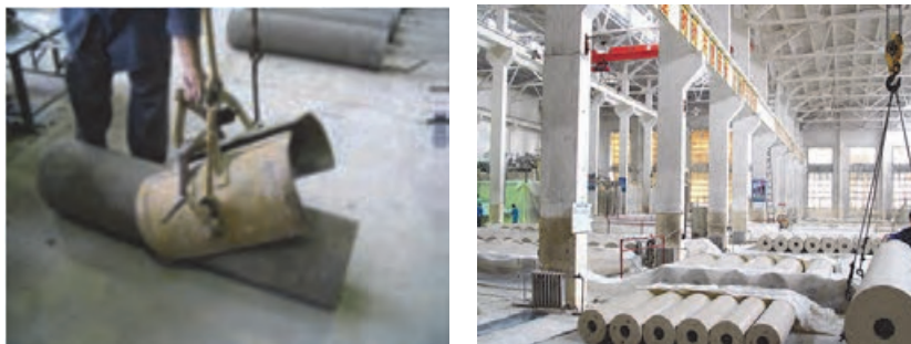
شکل ۲۲- جابه‌جایی شمش‌ها به کمک جرثقیل
