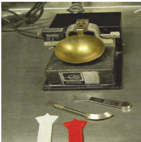
شکل ۱۴- جام کاساگرانده و شیارزن
