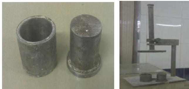
شکل ۱۷- دستگاه ففرکورن و قالب نمونه‌ساز
