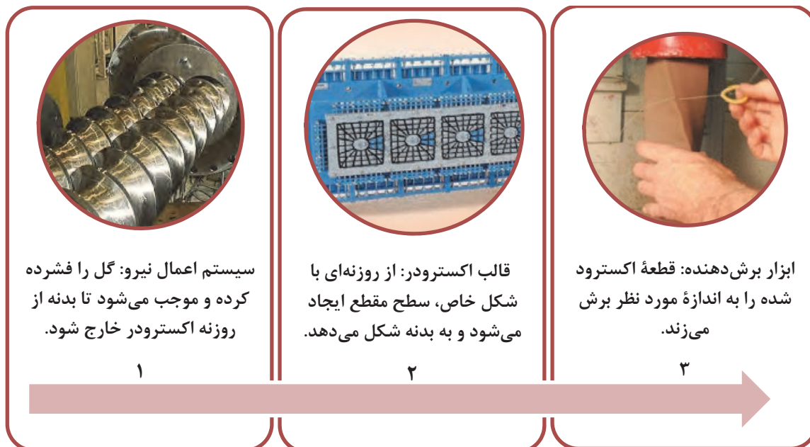
شکل ۶- اجزاء ماشین اکسترودر
