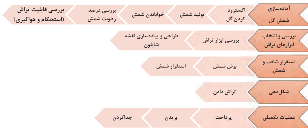
شکل ۷- مراحل شکل‌دهی گل پلاستیک به روش تراش
