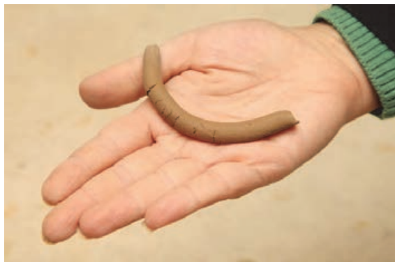
شکل ۱۵- بررسی فتیله در روش آتبرگ
