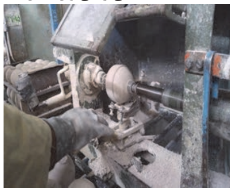
شکل ۵- شکل‌دهی قطعات سرامیکی به روش تراش
