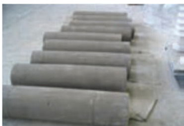
شکل ۲۰- برش شمش با طول مناسب
