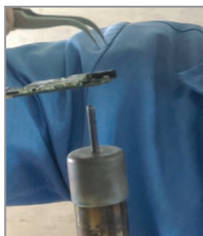
شکل ۲-۸ حرارت از زیر برد
