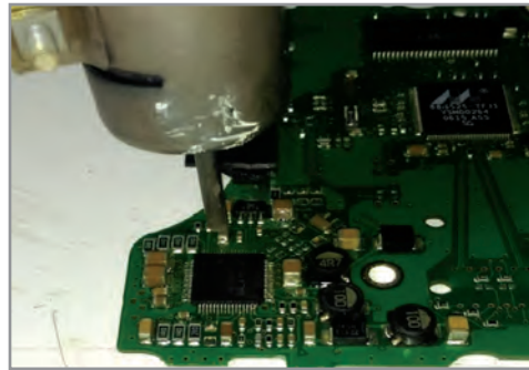
شکل ۲-۴ دمونتاز آی سی های چهار طرفه (خرچنگی)
