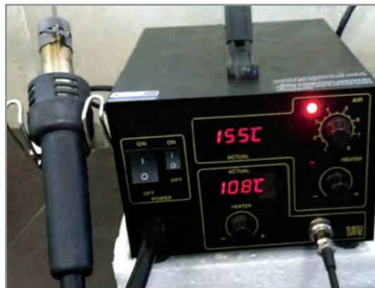
شکل ۱-۱ یک دستگاه هویه هوای گرم
