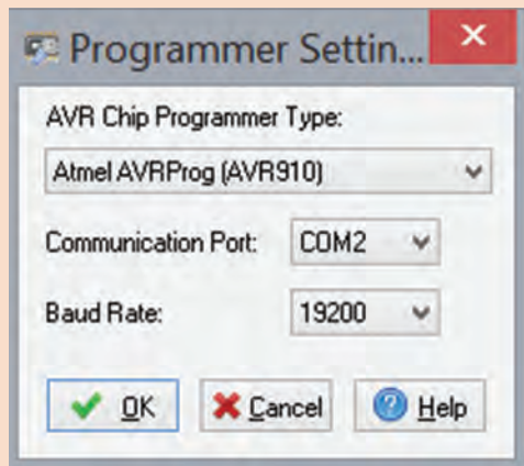
شکل ۷-۲۱ تنظیم پورت و سرعت پروگرامر AVR ۹۱۰
