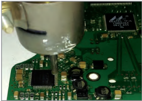
شکل ۲-۴ دمونتاز آی سی های چهار طرفه (خرچنگی)
