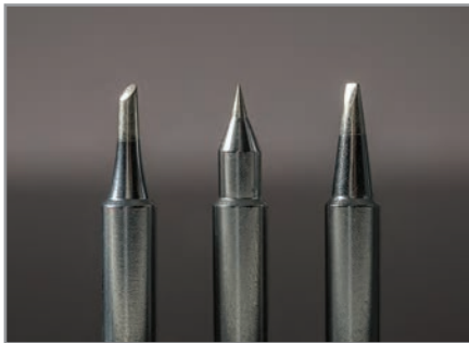
شکل ۸-۱ سه نمونه نوک هویه SMD
