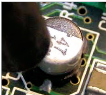
شکل ۲-۳ دمونتاز خازن سرامیکی و الکتrolیت SMD
