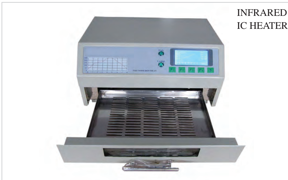
شکل ۳-۱۸ دستگاه کوره جهت ذوب کردن خمیر لحیم
