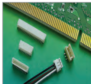
شکل ۲-۶ کانکتور پلاستیکی SMD
