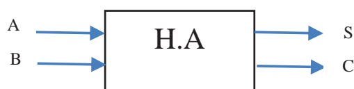
شکل ۵-۲ بلوک دیاگرام جمع کننده ناقص
