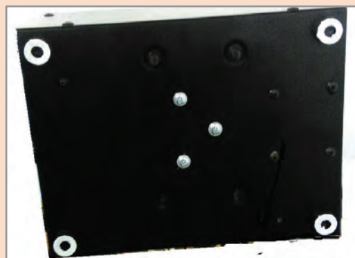
شکل ۱-۴ سه پیچ قفل کننده کمپرسور به بدنه
