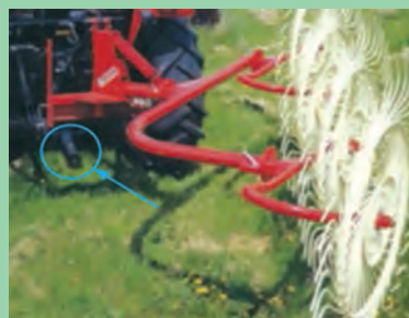
شکل ۹- اتصال شانه خورشیدی به تراکتور
