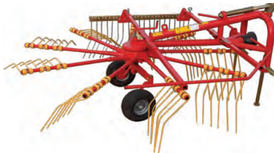
شکل ۱- شانه دوار
