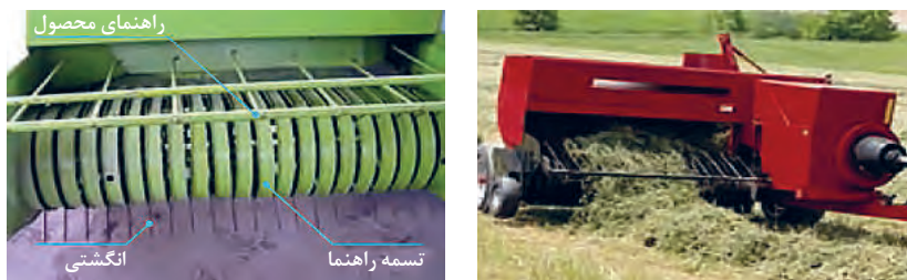
شکل ۴- واحد بردارنده
