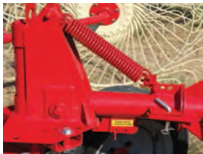
شکل ۱۰- فنرهای شناوری
