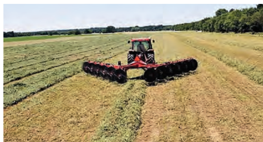
شکل ۸- شانه چرخي دوقلو با چرخ های یکپارچه
