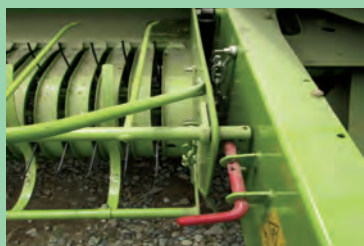
شکل ۱۵- پین نگهدارنده بردارنده
