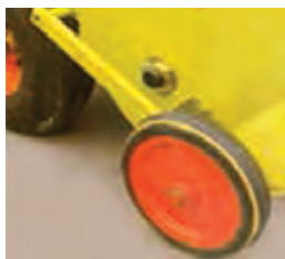
شکل ۱۹- چرخ نگهدارنده واحد بردارنده
