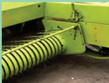
شکل ۲۰- تنظیم ارتفاع بردارنده
