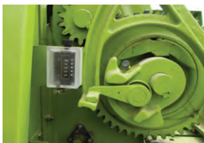
شکل ۲۶- شماره‌انداز بر روی دستگاه بسته‌بند
