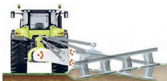
شکل ۱۲- حالت‌های کاری دروگر استوانه‌ای در شیب
