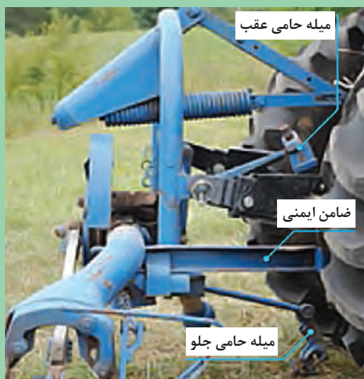
شکل ۲۱- نحوه اتصال دروگر شانه‌ای به تراکتور
