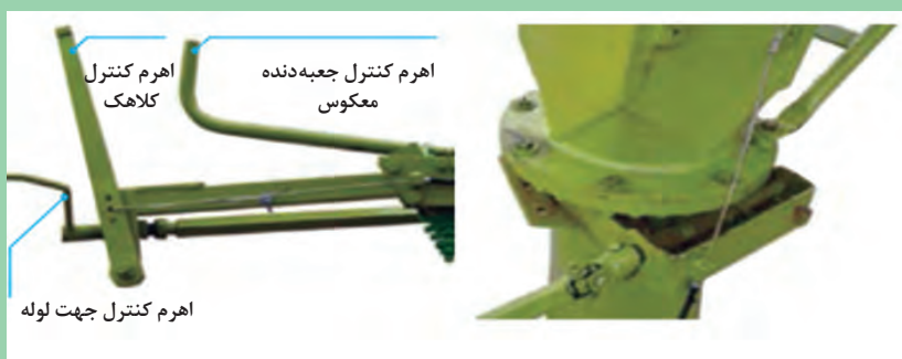
شکل ۶۱- اهرم‌های کنترل در اختیار کاربر
