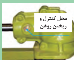
شکل ۶۶- جعبه دنده زانویی تیغه درو
