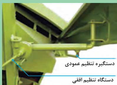
شکل ۵۰- دستگیره‌های تنظیم صفحه جداکننده محافظ علوفه
