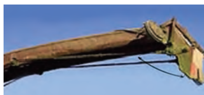
شکل ۵۸- حرکت عمودی کلاهک لوله تخلیه
