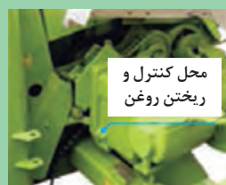
شکل ۶۵- جعبه دنده باردهی غلتک‌های تغذیه
