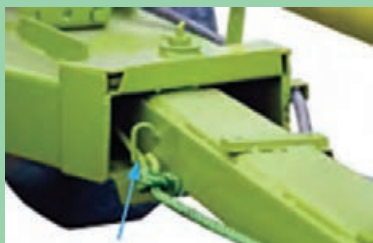
شکل ۷۰- طناب آزادکننده پین
