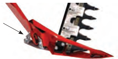
شکل ۳۱- کفشک تنظیم ارتفاع برش
