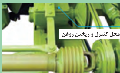
شکل ۶۳- جعبه دنده معکوس کننده
