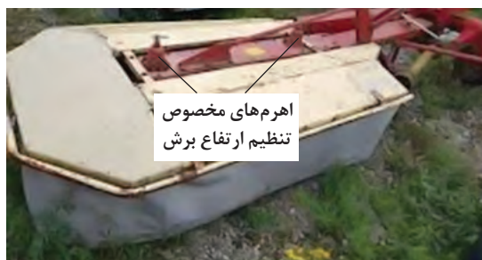
شکل ۲۸- اهرم‌های مخصوص تنظیم ارتفاع برش
