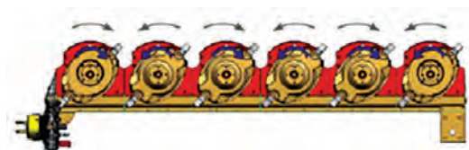
شکل ۸- جهت چرخش بشقاب‌ها در دروگر بشقابی
