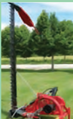
شکل ۲۶- دروگر شانه‌ای در دو وضعیت کار و حمل و نقل
