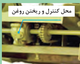
شکل ۶۷- جعبه دنده دوکفه‌ای
