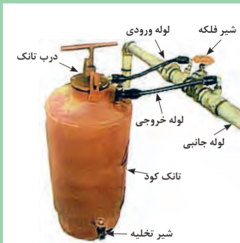
شکل ۳۳- اجزای سیستم توزیع کود
