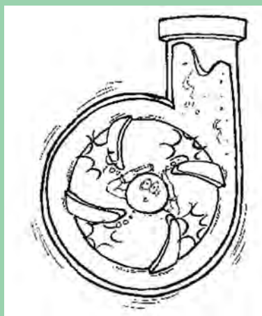
شکل ۱۵- کاویتاسیون در پروانه پمپ
