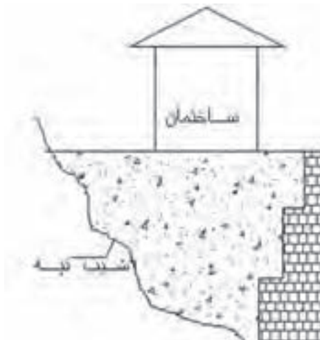
شکل ۱-۶: شماتیک دیوار حائل در مقابل ریزش خاک
