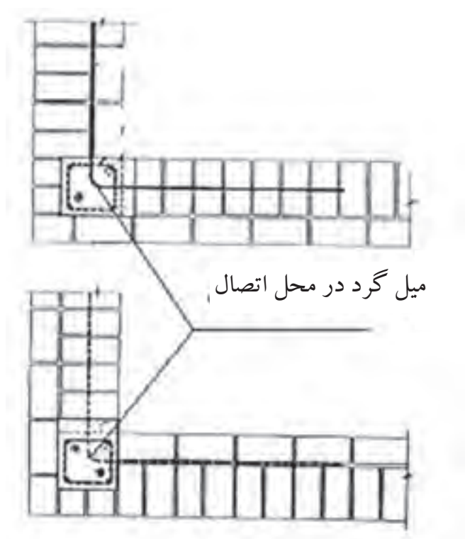
شکل ۱ - ۵۰: رعایت اصول اتصال دو دیوار
