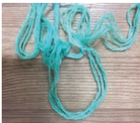
رنگرزی نامرغوب نخ
