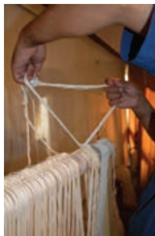
شکل ۱۱-۵ - باز کردن گره‌های سردار
