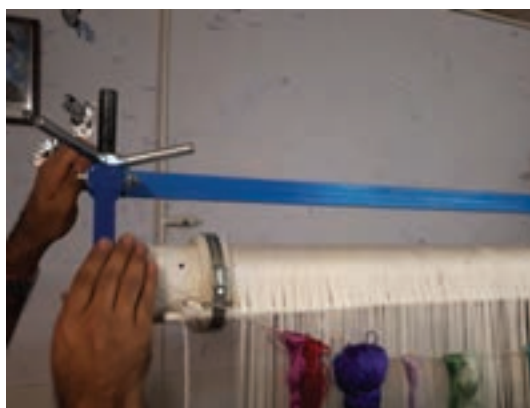
شکل ۳۵-۵ - شل کردن دار
