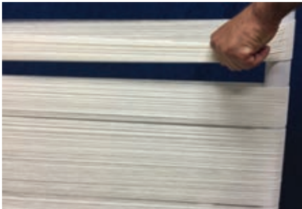
شکل ۳۰-۲- تنظیم تارها بر روی میله
