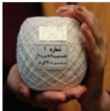
شکل ۱۶-۲- توپک ۲۰۰ گرمی، چله پنبه ای ۱۲ لا نمره ۲۰
