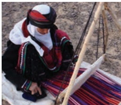
شکل ۱۹-۳- چله‌ریزی بر روی دستگاه برای بافت جاجیم
