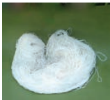
شکل ۱۳-۲-۱۰۰ گرم چله ابریشمی ۴۲ لا (رجشمار ۵۰) شکل ۱۴-۲-۱۰۰ گرم چله ابریشمی ۳۶ لا (رجشمار ۶۰) شکل ۱۵-۲-۱۰۰ گرم چله ابریشمی ۳۰ لا (رجشمار ۷۰)
