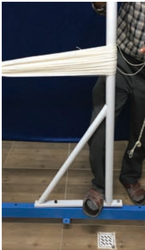
شکل ۳۸-۲- بستن انتهای چله به میله
