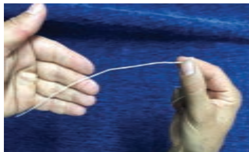
شکل ۱۰-۲- نخ چله پنبه‌ای در حالت کدري
