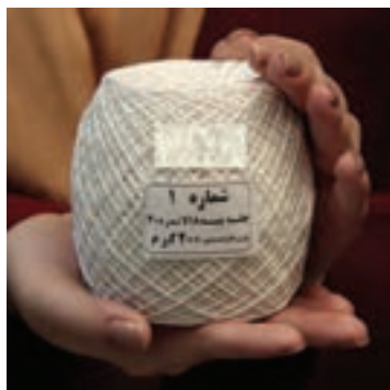
شکل ۱۸-۲- توپک ۲۰۰ گرمی، چله پنبه ای ۱۸ لا نمره ۲۰
