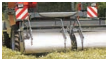
ماشین برداشت گل های بابونه با استفاده از روش شانه با حرکت دورانی و تخلیه خارجی
