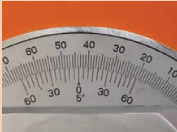
شکل ۱۴- اندازه گیری زاویه باز قطعه کار
