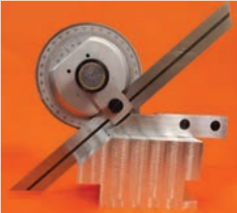
شکل ۱۴- اندازه گیری زاویه باز قطعه کار
