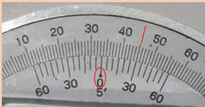
شکل ۱۲- اندازه تنظیمی با زاویه‌سنج
