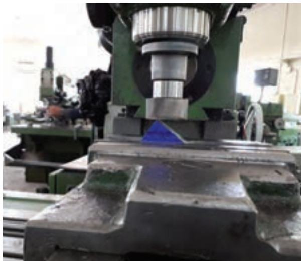
شکل ۱۷- خط کشی و بستن قطعه در گیره
