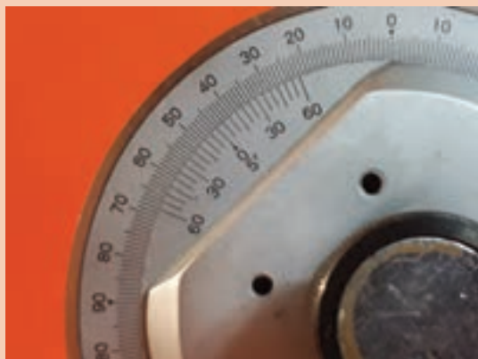
شکل ۲۲- کنترل زاویه قطعه شماره ۲ با زاویه سنج ۵ دقیقه
