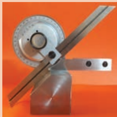
شکل ۲۲- کنترل زاویه قطعه شماره ۲ با زاویه سنج ۵ دقیقه
