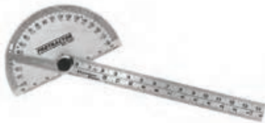
زاویه‌سنج ساده قابلیت تفکیک ۱ درجه
