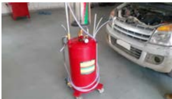
تعویض روغن موتور با ساکشن
