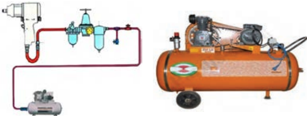
شکل ۹-۳- دستگاه کمپرسور و مدار پنوماتیک
