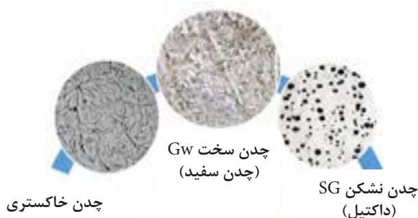
شکل ۱۹-۴- انواع چدن و شکل متالوگرافی آنها
