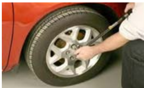
شکل ۴-۵- گشتاور لازم برای سفت کردن چرخ
