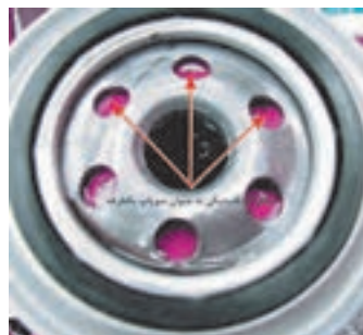
سوپاپ یک طرفه روغن
