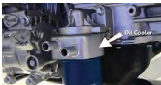
شکل ۸-۴ خنک کن روغن موتور
