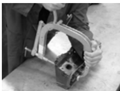
استفاده از فنر سوپاپ جمع کن دستی
