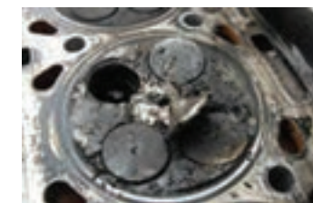
ذوب شدن سوپاپ
