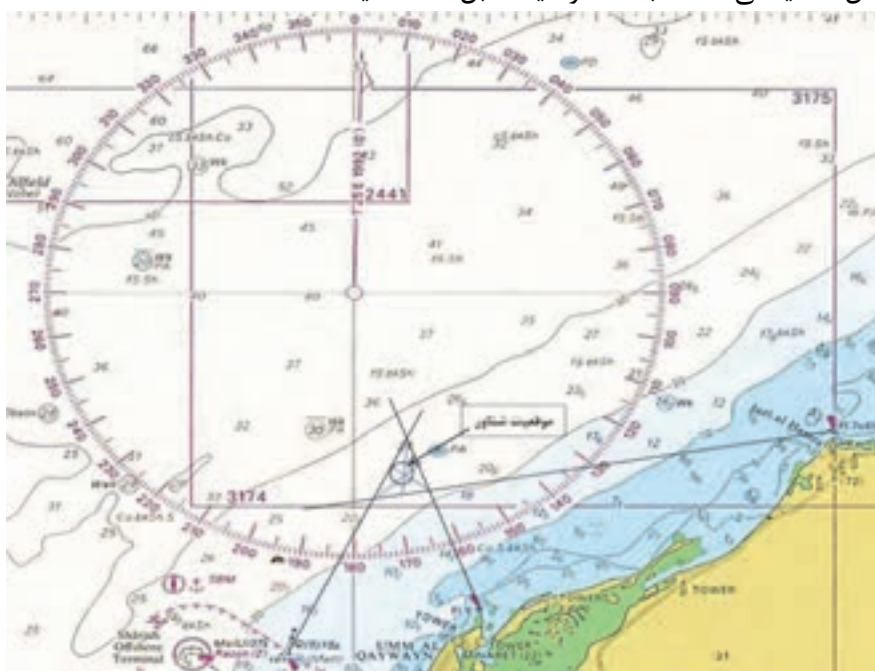
شکل ۶- تعیین موقعیت با استفاده از سه سمت
