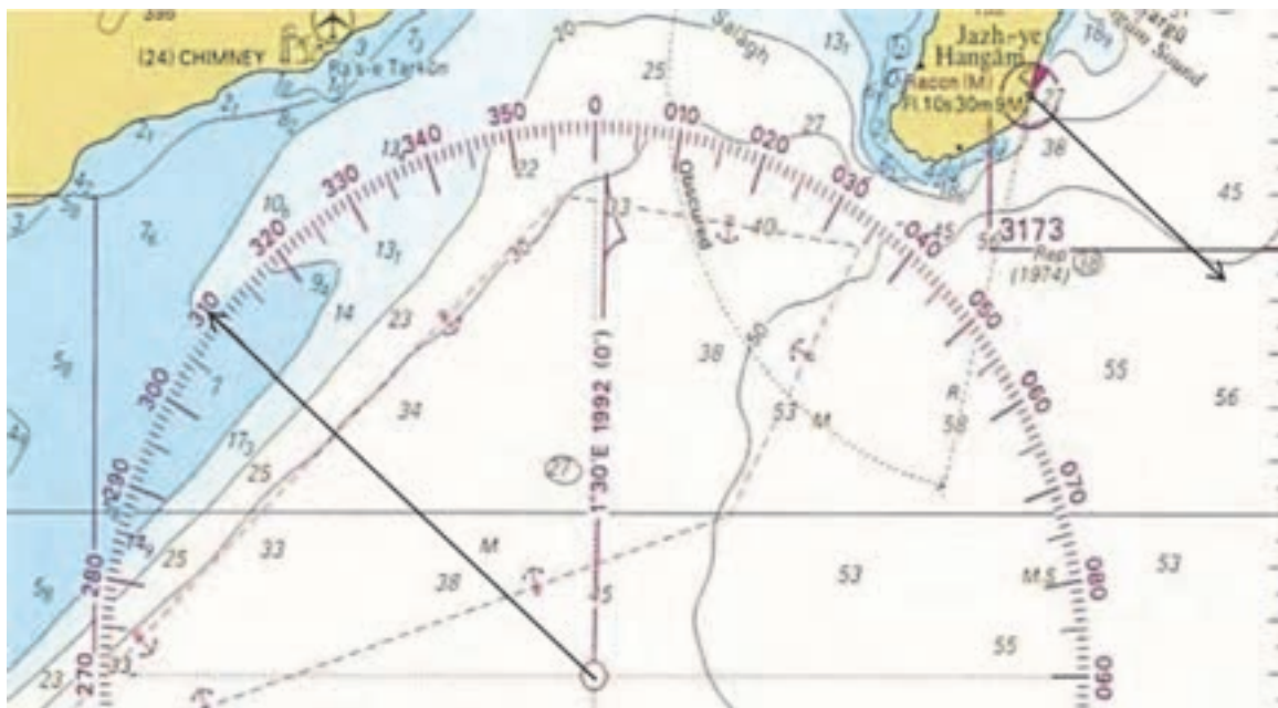
شکل ۵- روش ترسیم سمت یک شیء روی نقشه
