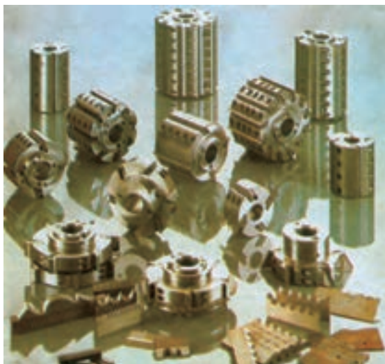
شکل ۴-۲۶- انواع توپی با تیغه‌های متفاوت
