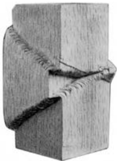
شکل ۵-۳۴ شکست چوب در اثر نیروهای فشاری
