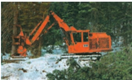
شکل ۲-۱۸- قطع درختان به وسیله ماشین های مخصوص با چرخ زنجیری که برای فصل زمستان مناسب است، انجام می شود.
