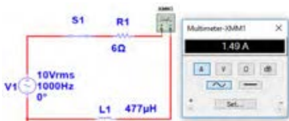
شکل ۴۱- ۵- مدار RL
