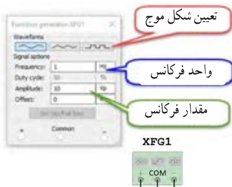
شکل ۳۵ - ۴ - فانکشن ژنراتور و صفحه تنظیم آن
