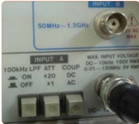
شکل ۴۹-۴ ورودی‌های فرکانس متر دیجیتالی
