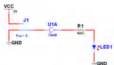
شکل ۵۹-۶ مدار گیت منطقی NOT
