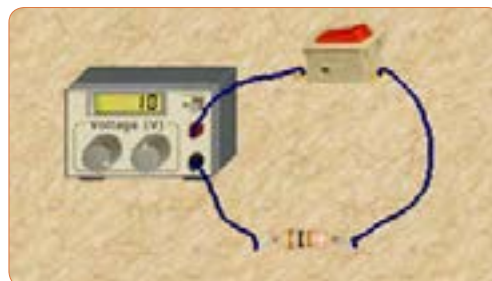
شکل ۲۲-۵- مدار آزمایش با مقاومت ۱۰۰ اهم
