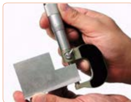
شکل ۱۶- ۲- چگونگی در دست گرفتن میکرومتر
