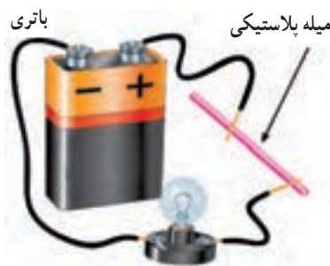
شکل ۲۰-۱ برقرار نشدن جریان الکتریکی در عایق
