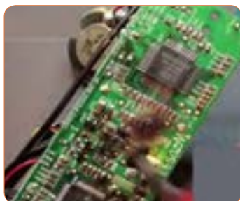
شکل ۵-۵ - قطعاتی از برد سوخته است.
