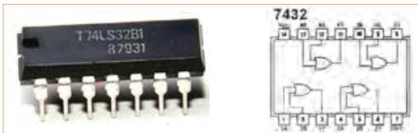
شکل ۵۳-۶- نمای ظاهری و اتصال پایه ای آی سی ۷۴۳۲
