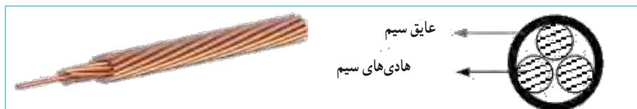
شکل ۱۱ - ۲ - سطح مقطع سیم نیمه افشان
