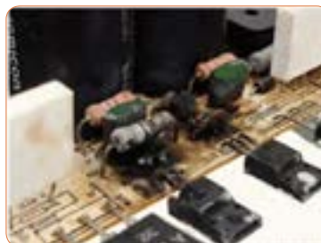
شکل ۲۴ - ۵- آسیب قطعات در یک برد
