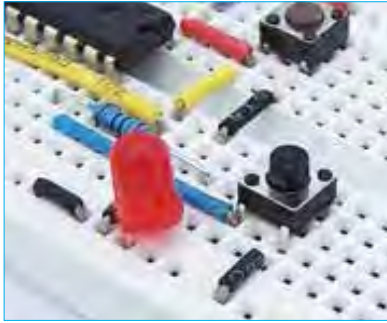
شکل ۸۷-۱ اتصال قطعات روی برد
