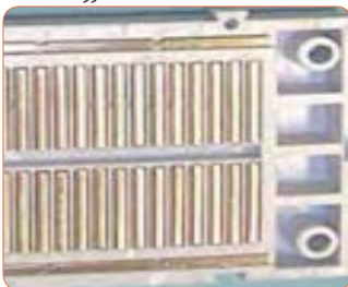
شکل ۸۹-۱ اتصالات داخلی برد بُرد
