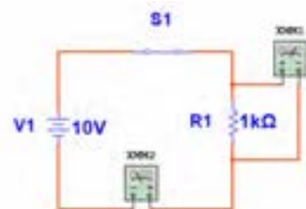
شکل ۲۱-۵- مدار آزمایش با آمپرمتر
