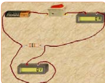
شکل ۴۵-۳- مدار با ولت متر و آمپر متر
