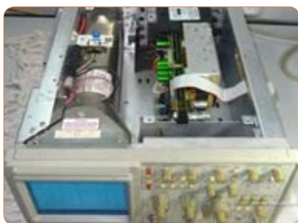
شکل ۵۲-۴ ساختمان داخلی یک نوع اسیلوسکوپ
