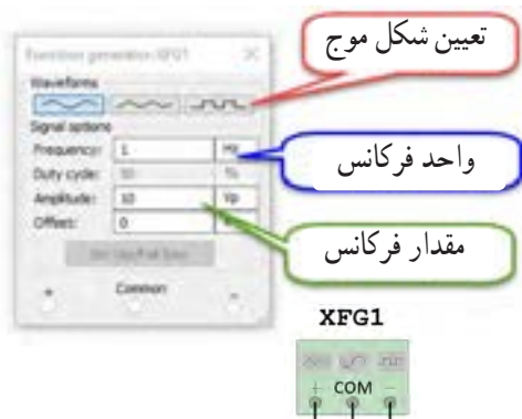
شکل ۳۵ - ۴ - فانکشن ژنراتور و صفحه تنظیم آن
