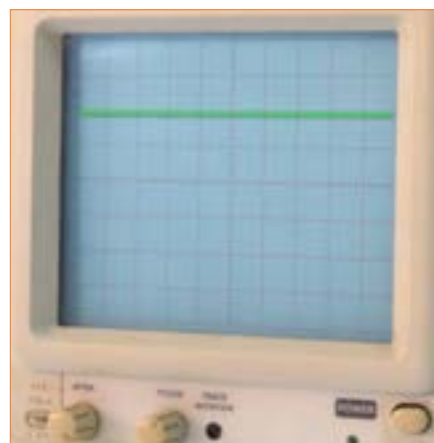
شکل ۷۴-۴- موج DC روی صفحه نمایش
