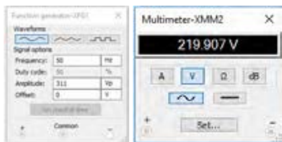
شکل ۳۹-۴ شبیه‌سازی ولتاژ برق شهر
