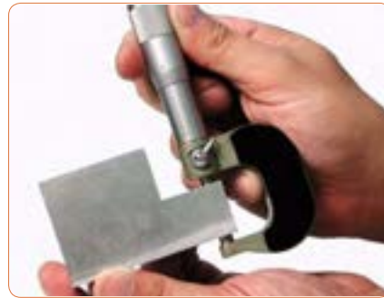
شکل ۱۶- ۲- چگونگی در دست گرفتن میکرومتر
