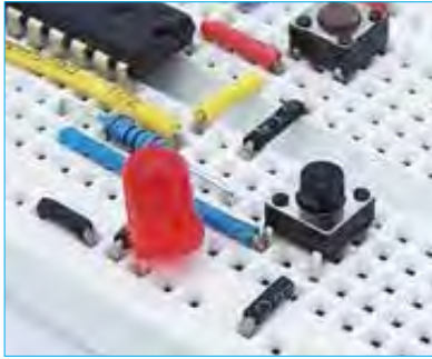
شکل ۸۷- ۱- اتصال قطعات روی برد برد
